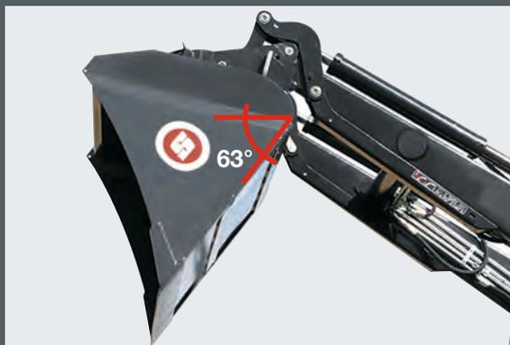
La pala si svuota completamente: l'angolo di scarico dell'attrezzo consente di lavorare in modo efficiente.
