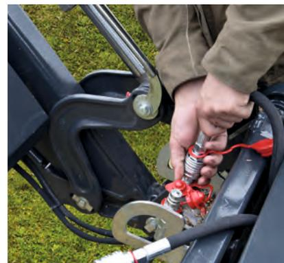
**3** Innesto del collegamento idraulico.
