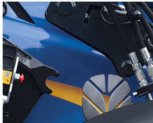
**1** Durante l'aggancio il caricatore frontale scorre sull'elemento di connessione fino a quando il perno di bloccaggio tocca l'estremità superiore della guida di scorrimento.
