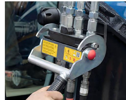
**2** Con Hydro-Fix tutti i tubi idraulici possono essere collegati al trattore simultaneamente. Il caricatore frontale viene sollevato leggermente per fissare il perno di bloccaggio nel gancio di blocco della guida di scorrimento.
