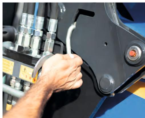
**3** Abbassando la leva di bloccaggio il caricatore frontale viene fissato saldamente all'elemento di montaggio. Per poi essere sollevato ulteriormente.
