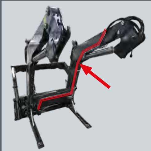
Posa dei tubi per REAL3 rd
