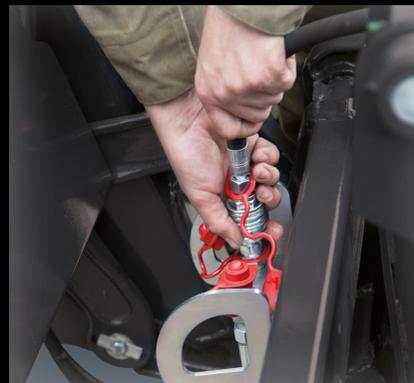
**3** Innesco del collegamento idraulico.
