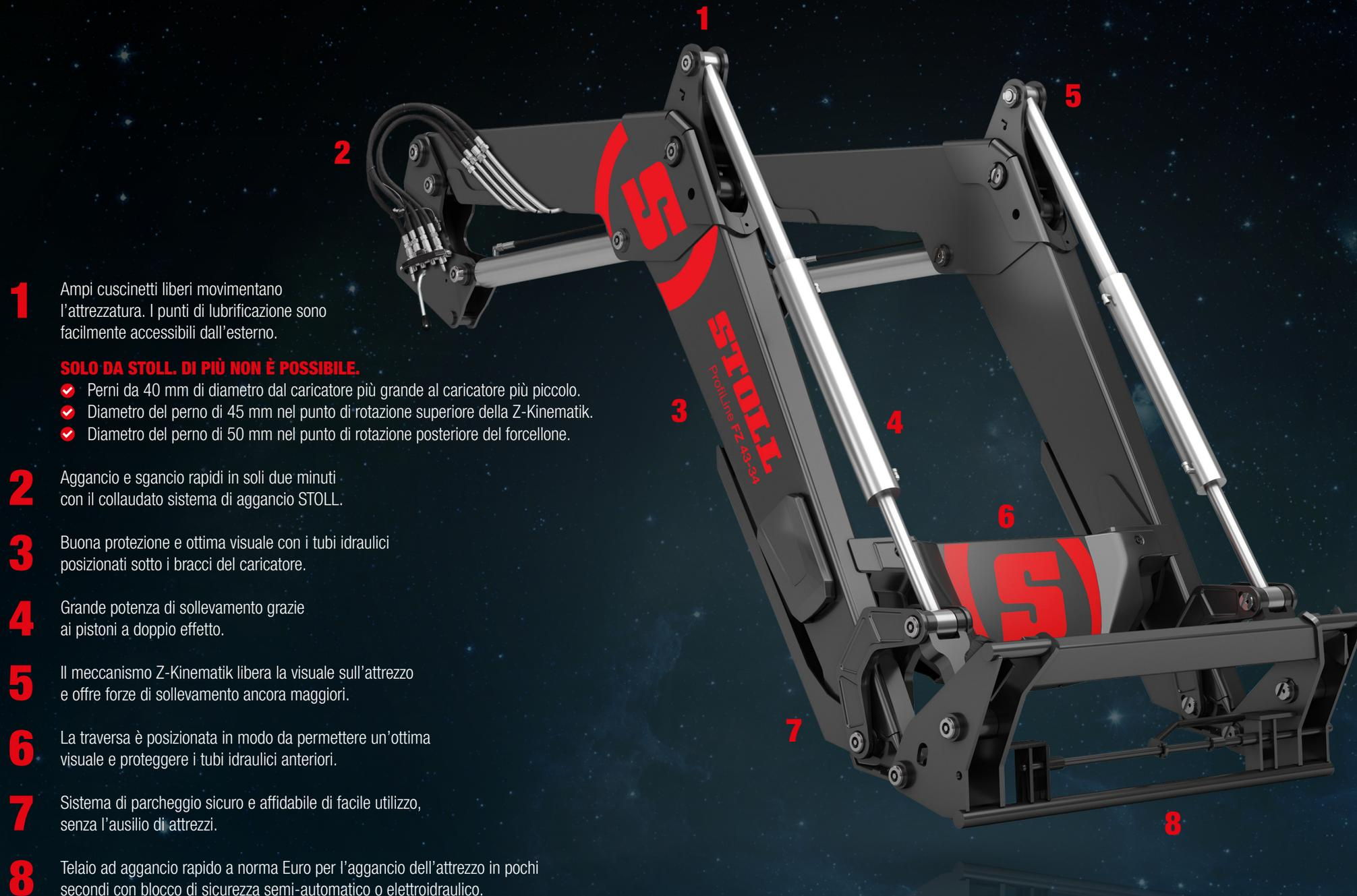
**1** Ampi cuscinetti liberi movimentano l'attrezzatura. I punti di lubrificazione sono facilmente accessibili dall'esterno.
