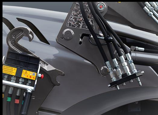
**1** Durante l'aggancio il caricatore frontale scorre sull'elemento di connessione fino a quando il perno di bloccaggio tocca l'estremità superiore della guida di scorrimento.
