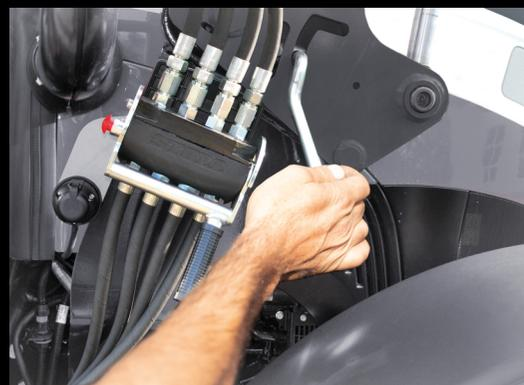
**3** Abbassando la leva di bloccaggio il caricatore frontale viene fissato saldamente all'elemento di connessione. Per poi essere sollevato ulteriormente.
