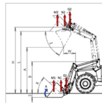
I valori riportati sono medie. I dati possono variare per eccesso o per difetto, a seconda del modello di trattore. Per il modello FC 150 la pressione idraulica è di 140 bar, per tutti gli altri caricatori frontali è di 170 bar. \*Per scongiurare il pericolo di ribaltamento del trattore, i lavori con il caricatore frontale sono ammessi solo in presenza di un contrappeso posteriore.
