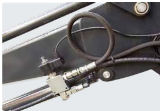
Impedisce l'abbassamento improvviso del caricatore frontale ed è conforme ai requisiti della norma EN 12525/A1.
