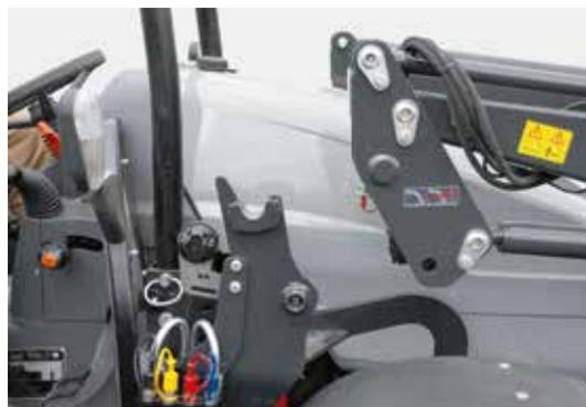
Il caricatore frontale si parcheggia in poche mosse. La colonna di attacco viene tolta dall'elemento di connessione, i piedini di parcheggio abbassati e i tubi idraulici scollegati.
