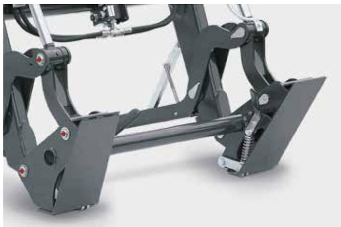
Il telaio ad aggancio rapido Skid Steer per tutti i caricatori frontali della serie CompactLine rende molto più facile e veloce la sostituzione dell'attrezzo terminale.
