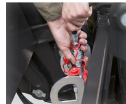
**3** Innesto del collegamento idraulico.
