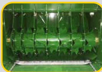
Il rotore di alimentazione è dotato di 56 lame montate su sette dischi ed è azionato da un motore idraulico. Ciò garantisce un'alimentazione uniforme delle balle.
