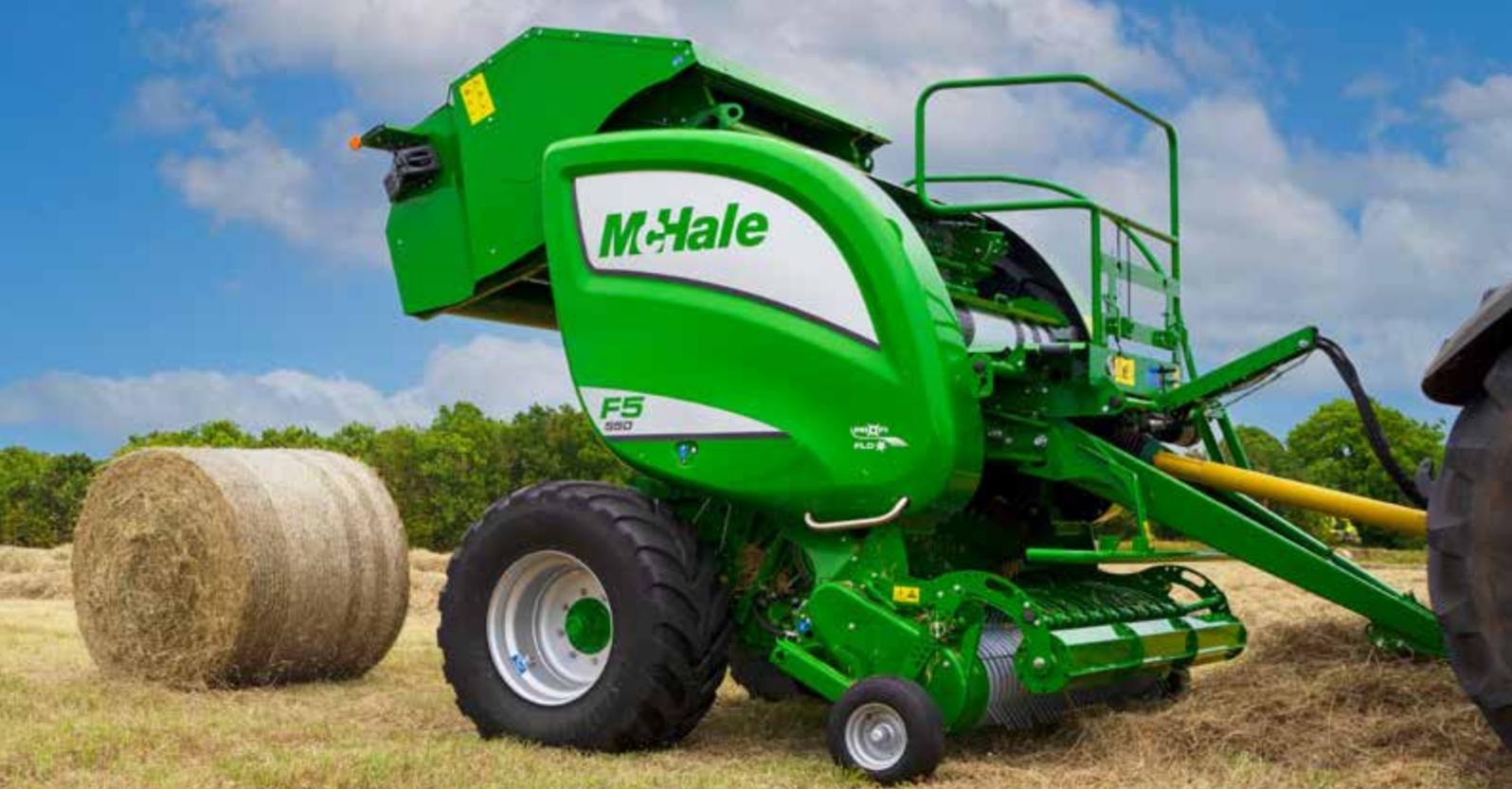
McHale offre quattro presse nella sua gamma di presse fisse F5: tre presse per legatura a rete e una pressa per legatura con pellicola. Tutte le presse della gamma McHale F5 a camera fissa producono balle di 1,25 m per 1,23 m (4'1" per 4').
