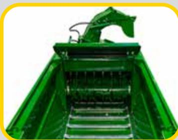
Il corpo macchina è stretto nella parte inferiore e si assottiglia man mano che la macchina si alza, per una maggiore visibilità. Quando la balla gira nella macchina, il materiale sciolto cade all'interno del corpo macchina.
