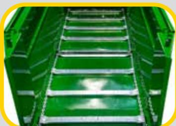
Il trasportatore a pavimento è un trasportatore a catena e a lamelle ad azionamento idraulico. Il formato delle lamelle assicura un'alimentazione uniforme e costante al rotore.
