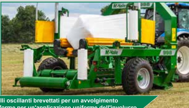
Rulli oscillanti brevettati per un avvolgimento uniforme per un'applicazione uniforme dell'involucro
