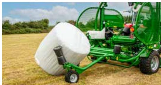
Quando si rovescia la palla, il rullo di avvolgimento posteriore si sposta verso il basso per depositare delicatamente la palla ben avvolta sul terreno.
