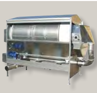
La griglia del tamburo ha due strati. La griglia interna seleziona le grosse impurità mentre quella esterna rimuove le piccole impurità dal prodotto.
