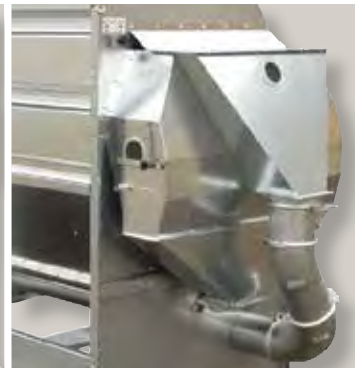
Una manopola situata all'esterno della cabina permette di regolare l'aspiratore senza l'utilizzo di attrezzi.
