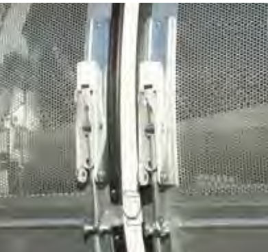
Le griglie sono montate facilmente grazie ad un sistema di sgancio rapido. Non sono richiesti attrezzi.
