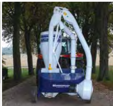
Equipaggiamento di carico con chiusura idraulica per la posizione di trasporto.
