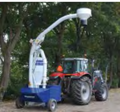
Equipaggiamento di carico sul modello SupraVac 2000 , pronto per caricare il grano nell'autocarro.
