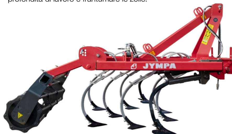
Modello NEPER-V9 con telaio a estensione idraulica e punte a coda di rondine
