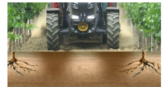
Il continuo passaggio di trattori e macchine pesanti tra i filari del vigneto o del frutteto compatta il terreno rendendo difficile lo sviluppo corretto delle radici.
