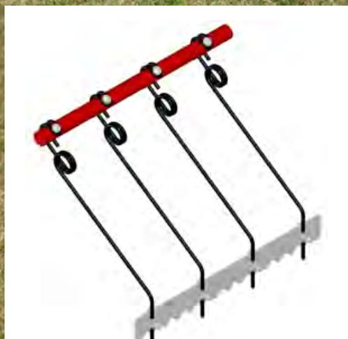
Una barra di livellamento su molla piatta, montata anteriormente alle 6 file di denti assicura protezione dal troppo carico. Questo tipo di barra, regolabile in altezza, è ideale per spianamenti e parziali interrimenti di accumuli di letame, di terra o di sostanza organica in genere. La posizione della barra può essere modificata senza problemi.
