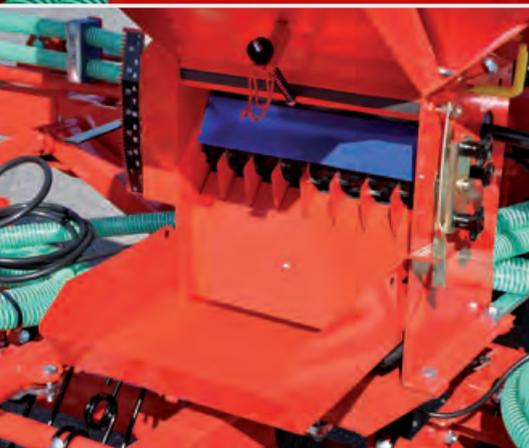
Il **recipiente di calibrazione** e il coperchio sono standard sulle macchine
