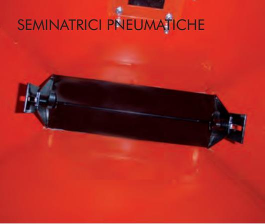
Per i semi pesanti, si raccomanda di applicare la **piastra di ritenzione** sopra l'albero agitatore e il rocchetto di semina.
