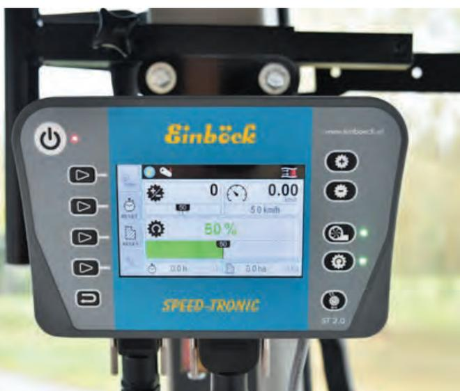
La PNEUMATICSTAR e la PNEUMATICSTAR-PRO possono essere equipaggiate con l'unità di controllo SPEED-TRONIC. Diventano così PNEUMATICSTAR-STI e PNEUMATICSTAR-PRO-STI.
