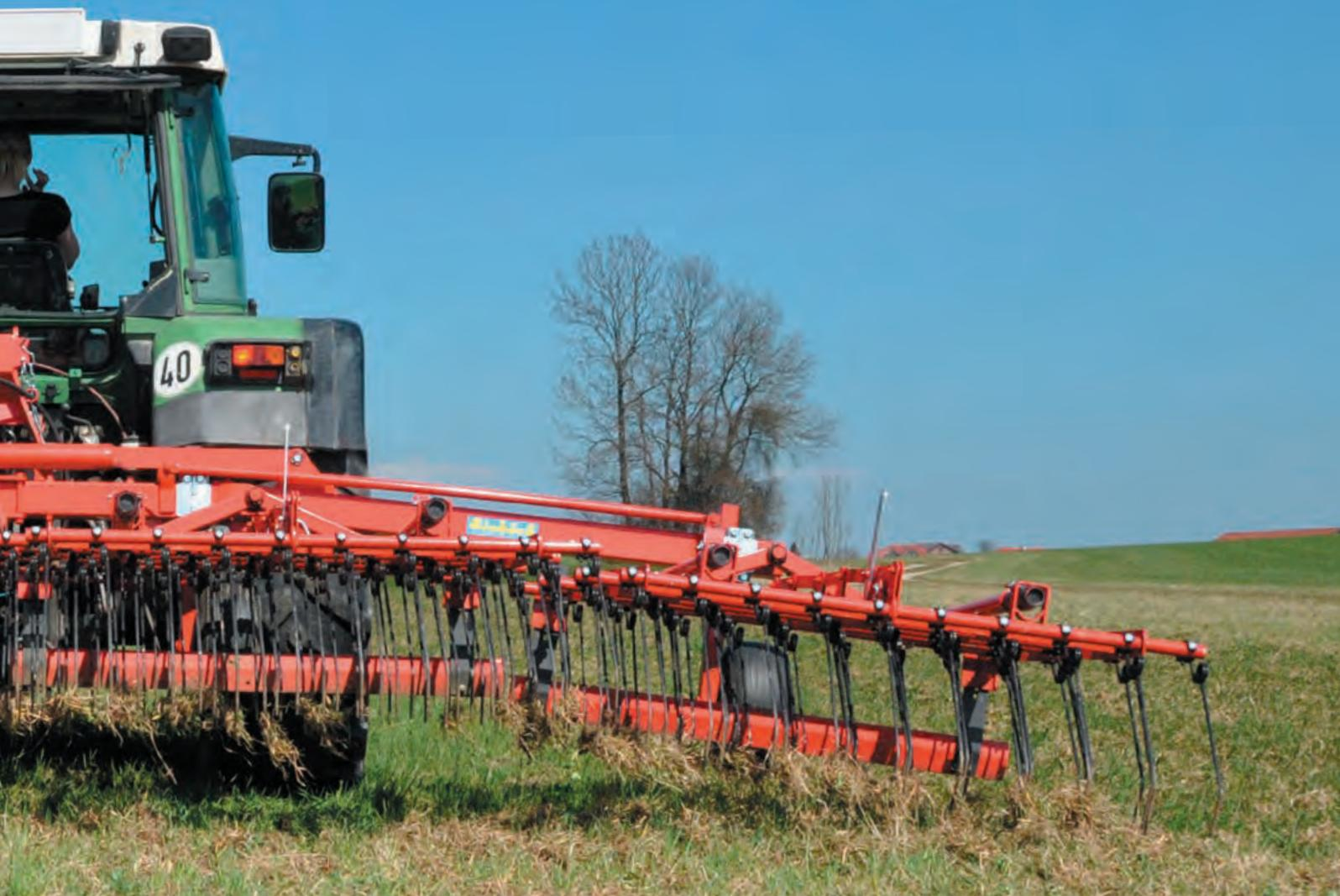
Togliendo la piastrina di fermo sull'ala (solo per macchine senza chiusura idraulica sdoppiata) **la macchina segue perfettamente il profilo del terreno.**
