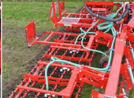
■ I giunti sono costituiti da bulloni del diametro di 35 mm e boccole in ottone e possono essere ingrassati. Modificando la posizione della piastra di fermo, le ali possono abbassarsi ulteriormente. Così non solo le sezioni striglianti ma anche le lame livellanti seguono il profilo del terreno.
