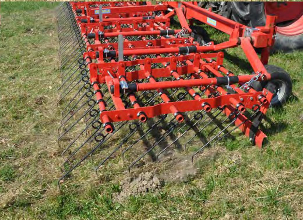
**Nei prati con molto feltro** di materiale o su terreni pesanti, devono essere utilizzati i denti da 10 mm di diametro e lunghi 490 mm (solo per la serie PRO e per i „telai pesanti“).
