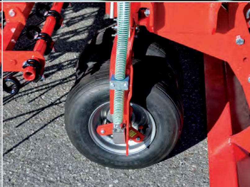
■ **Trasmissione per mezzo della ruota di supporto (PNEUMATICSTAR).**
