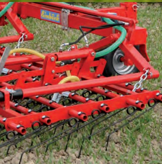
La regolazione dei denti idraulica facilita l'uso di GRASS-MANAGER, PNEUMATICSTAR e PNEUMATICSTAR-STI anche nelle condizioni di terreno più disparate. E' anche molto comodo per disporre i denti in posizione di trasporto (orizzontali). La regolazione idraulica può anche essere applicata successivamente.
