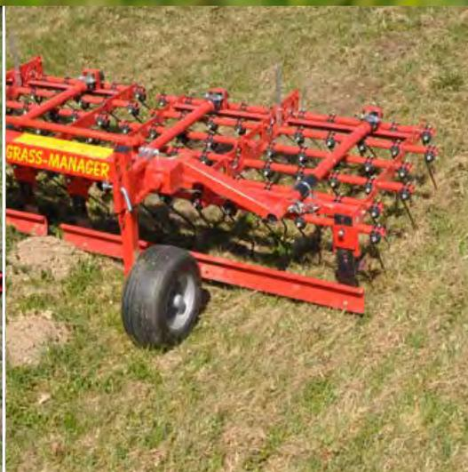
Le ruote di sostegno sono regolabili in altezza attraverso una piastra forata. La carreggiata delle ruote centrali è di 1,45 m, a richiesta si può avere anche la carreggiata da 1,8 m
