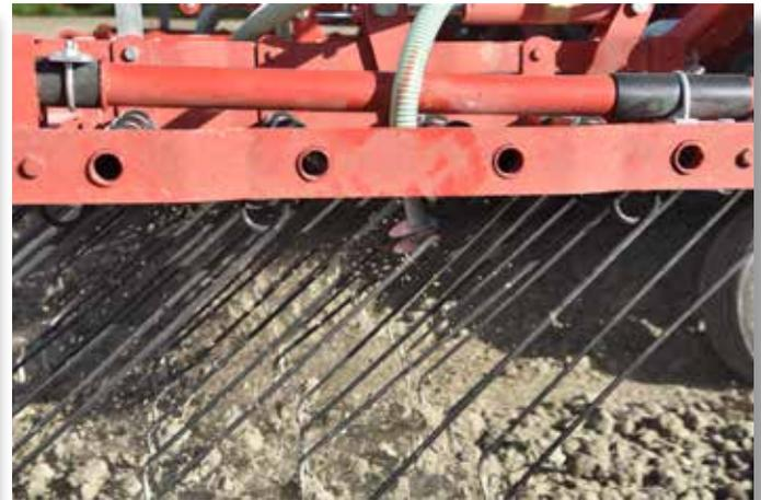
Interramento del seme nel terreno mediante l'azione di erpici strigliatori
