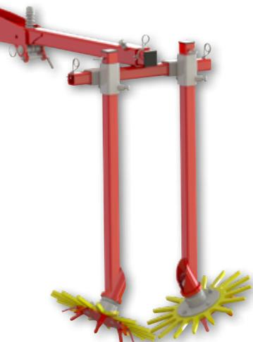
Ciascun telaio di supporto è dotato di una molla di spinta, regolabile secondo 3 livelli di durezza crescenti. Il livello sarà da selezionare in funzione delle condizioni del terreno. L'obiettivo è imprimere una forza sufficiente a far sì che le "finger weeders" si deformino ed operino costantemente parallele al terreno.
