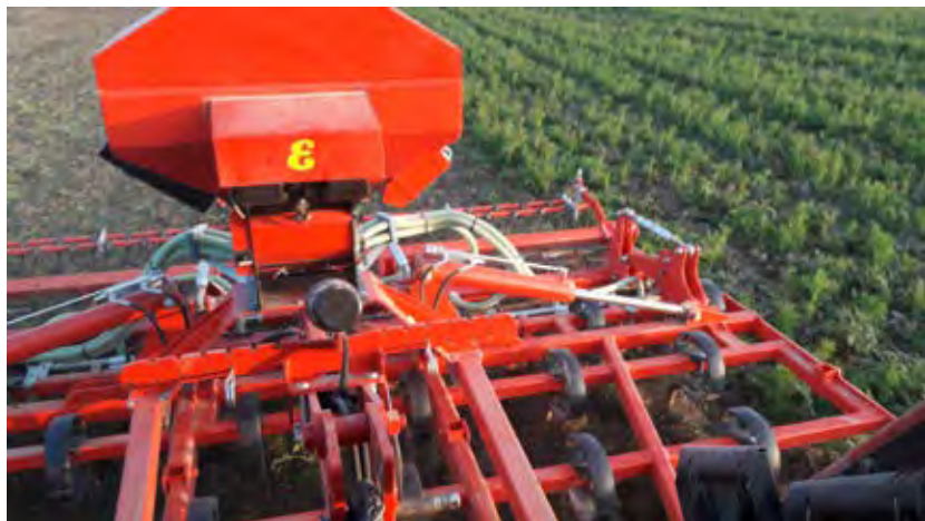
Preparatore del letto di semina con punte a piede d'oca (profondità 5 cm), taglia l'intera superficie e distrugge la cover crop. ATTENZIONE: il terreno non dev'essere sensibile al compattamento e al ristagno.
