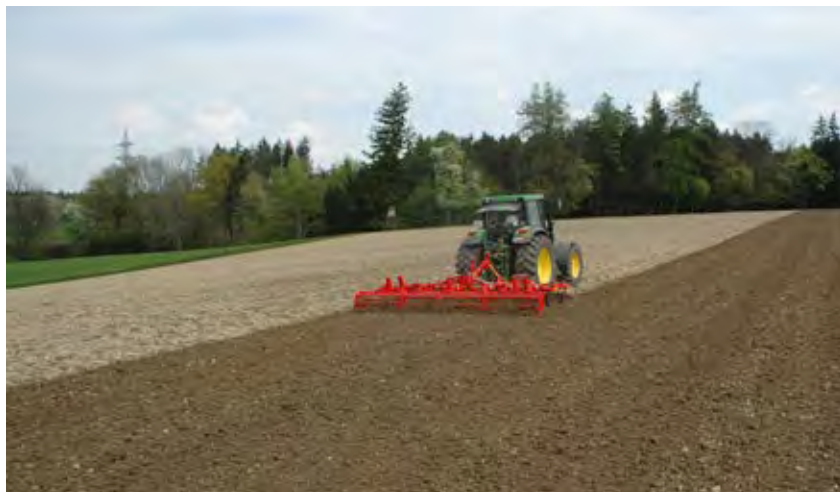
Preparazione del letto di semina in primavera, dopo la lavorazione autunnale. Effettuata con coltivatore con denti a molla.
