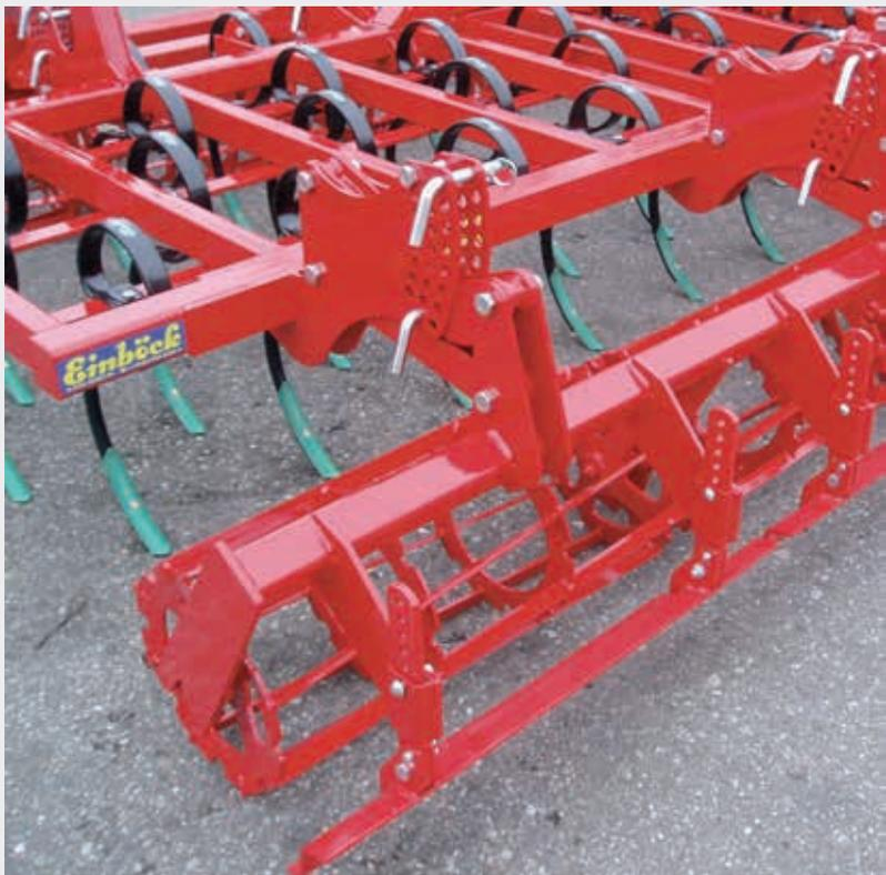
La **regolazione della profondità** è effettuata tramite un apposita piastra dotata di fori e di perni che garantiscono una lavorazione precisa. Un ulteriore regolazione tra i due rulli assicura uno sbriciolamento ottimale del terreno. Il movimento a parallelogramma assicura una regolazione uniforme tra i due rulli.
