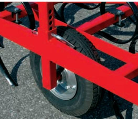
Per i modelli VIBROSTAR 4-350 e 4-610 se utilizzati senza rulli pareggiatori è consigliabile l'utilizzo della ruota di profondità collocata lateralmente.
