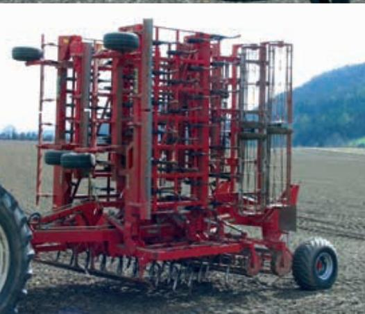
Il **VIBROSTAR 1210** è dotato di una struttura standard di sostegno e quattro ruote di supporto ai lati di ogni singola sezione fornite di serie con l'equipaggiamento dell'erpice.
