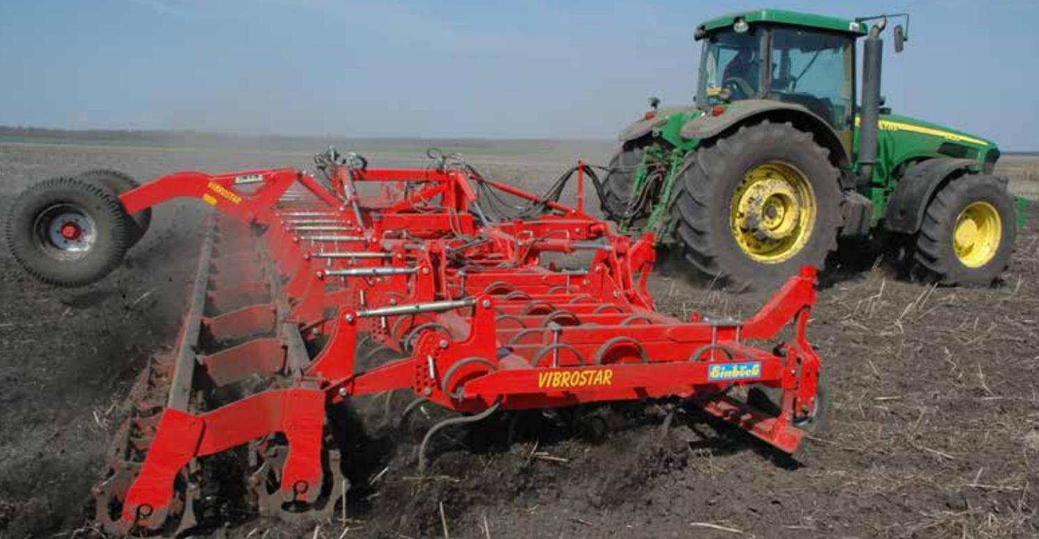
Se non viene utilizzato un rullo a gabbia o un erpicino a due file di denti sul VIBROSTAR 5-400 a 5-600, si raccomanda di ordinare **4 ruote di supporto in gomma**, integrate nell'ala laterale.
