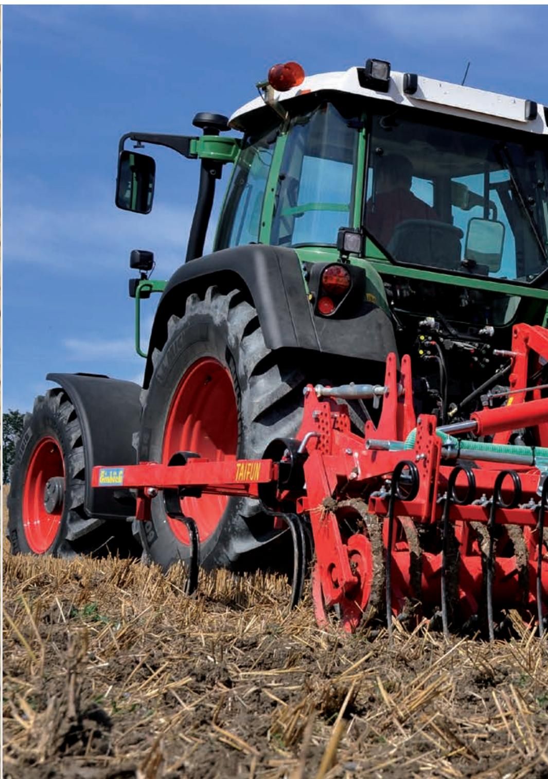
Specialmente per la semina di cover crops, sono disponibili traseminatori pneumatici con kit di montaggio completi, che possono essere facilmente montati su qualsiasi macchina.
