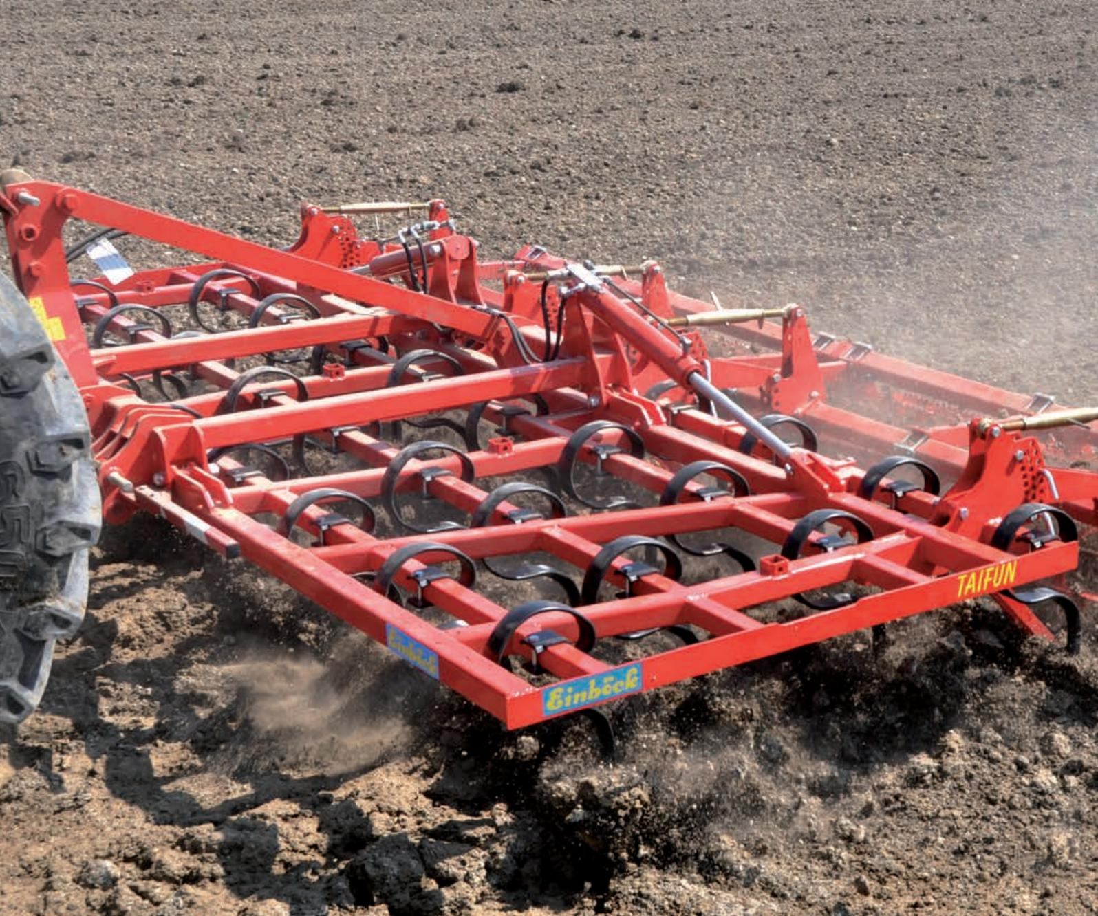
Sul TAIFUN, la **profondità di lavoro** viene regolata attraverso il terzo punto di attacco e il rullo posteriore. Tutta la pressione viene trasferita al rullo posteriore e questo garantisce un funzionamento della macchina molto regolare.
