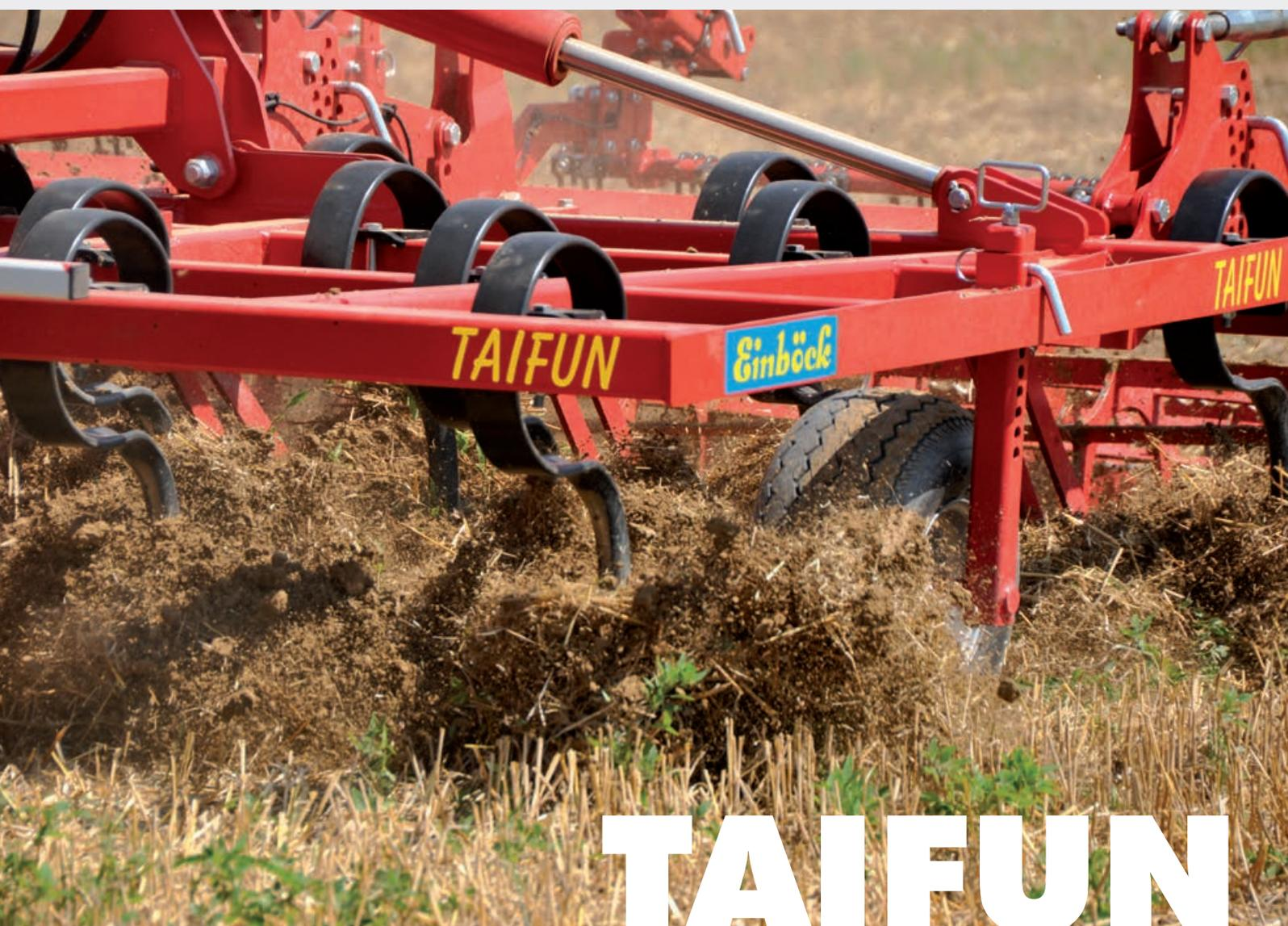
Le operazioni sopra descritte sono rese possibili da caratteristiche quali il telaio spazioso e la fila di denti livellatori situata tra l'ultima fila di denti elastici e il rullo posteriore. I forti denti elastici Vulcanus, in robusto acciaio e distribuiti su quattro file, sono progettati per una lunga vita utile.
