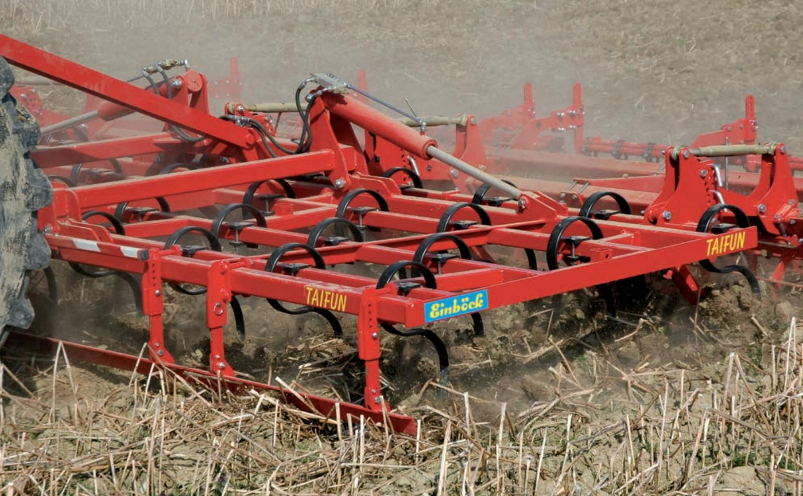
**La barra livellante** è fissata sulla parte anteriore del telaio e l'altezza di lavoro può essere regolata per mezzo di perni. La barra livellante rompe le zolle eventualmente presenti e può anche esserne regolata l'inclinazione. L'altezza di lavoro viene sempre mantenuta perfettamente e il lavoro degli utensili è molto regolare. In primavera è particolarmente raccomandato l'utilizzo della barra livellante, per la preparazione del letto di semina.
