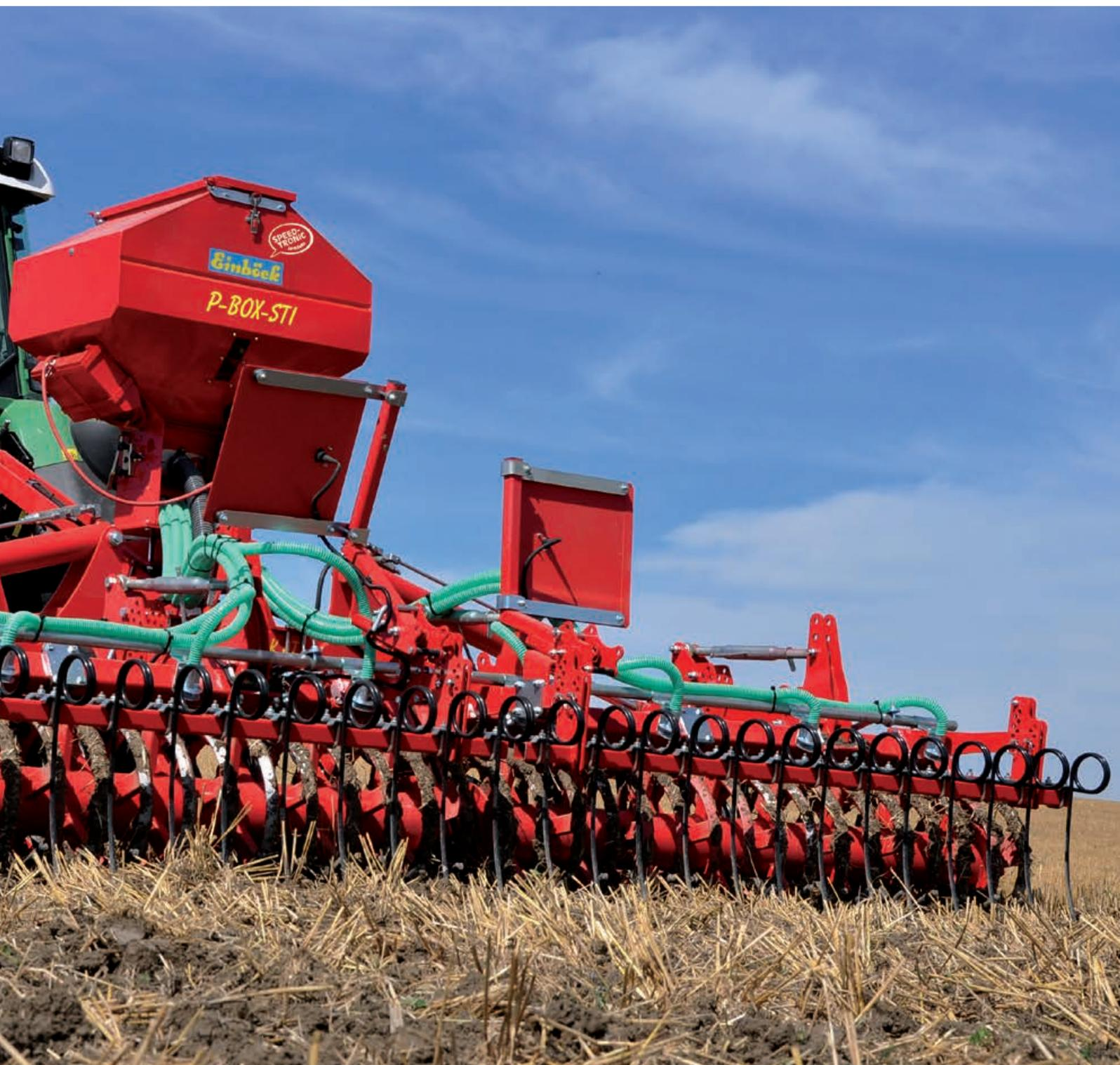
Con **P-BOX-MD**, **P-BOX-ED** e **P-BOX-STI**, è possibile seminare tutte le colture standard e loro miscele, fino ad una dimensione di 5 mm. Secondo la dose di semina e la velocità di lavoro, è possibile seminare qualsiasi dose compresa tra 1 Kg e 300 Kg/ha, con una semplice regolazione.
