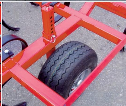
Grazie al **pistone idraulico di bloccaggio**, non sono necessari scomodi sistemi di blocco meccanico.
