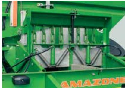
Le paratoie idrauliche permettono di disattivare la concimazione da un lato, ad es. per la fertilizzazione. Per distribuire calce umida, sterco di gallina secco, fanghi residuati secchi ecc. basta sollevare la paratoia con la manovella ed eventualmente abbassare il rastrello a catena.
