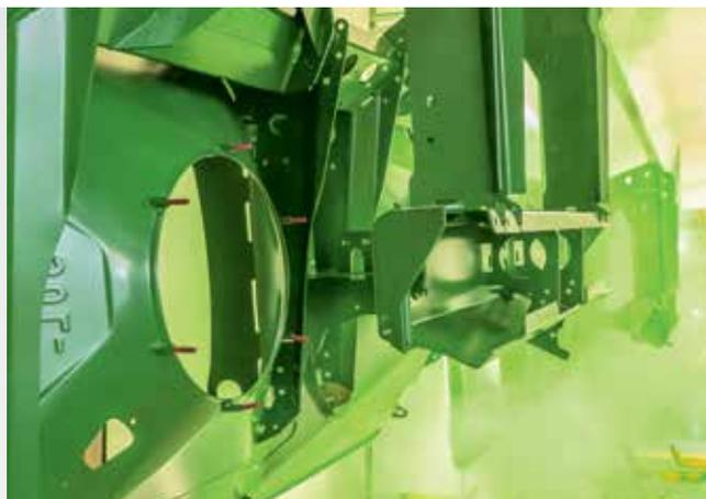
Doppia protezione mediante lo spesso strato aggiuntivo di rivestimento a polvere, che aumenta la protezione contro l'usura.
