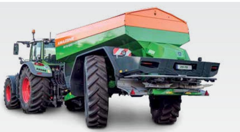
Asse di incidenza con angolo di sterzata fino a 28°
