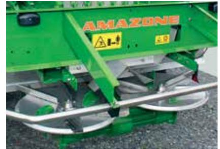
Dispositivi specifici: disco di spargimento per ossa polverizzate con rastrello a catena per un flusso di concime uniforme.
