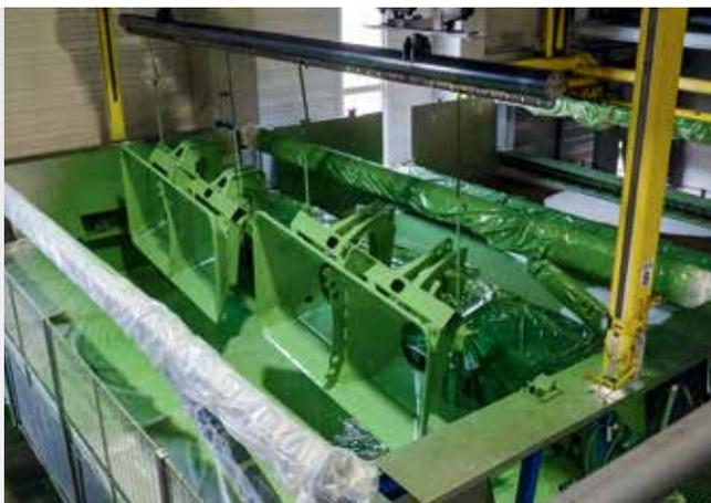
La prima mano di verniciatura catodica a immersione assicura una protezione contro la corrosione praticamente integrale di tutti i componenti.
