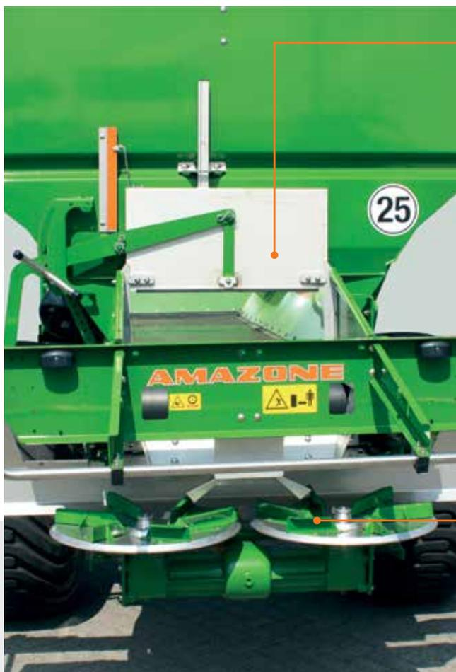
Paratoia di regolazione in acciaio inox per regolare la quantità da distribuire, con scala ben leggibile situata nel campo visivo diretto dell'operatore e facilmente regolabile.
