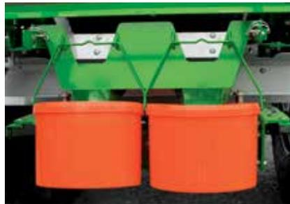
Il dispositivo di calibrazione permette di verificare la velocità del flusso di concime. In questo modo si può determinare con precisione la dose di applicazione.
