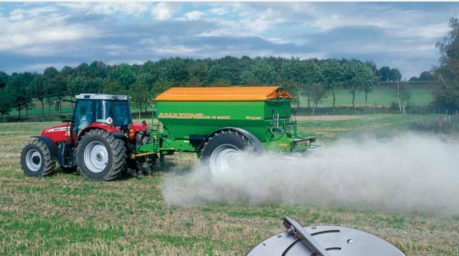
**Esattezza:** i dischi di spargimento TS con alette di spargimento orientabili creano una forma di spargimento di estrema precisione.
