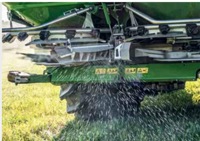
Quando viene attivato, il BorderTS dello ZA-TS gira sul ventaglio spargitore dall'alto. La speciale struttura a piattelli e il deflettore regolabile in continuo guidano delicatamente i granuli fino al terreno.
