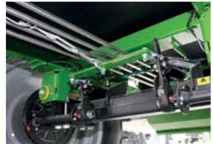
Il sistema di pesatura permette di mantenere sempre sotto controllo il livello di riempimento della tramoggia e la dose di applicazione.
