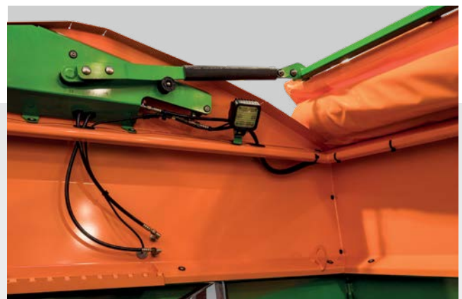
Luci di lavoro all'interno del serbatoio
