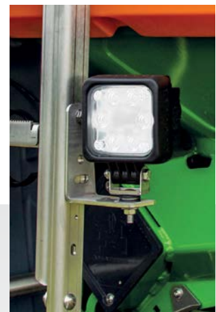
Quando le luci di lavoro restano accese, significa che il peso prestabilito è stato raggiunto.
