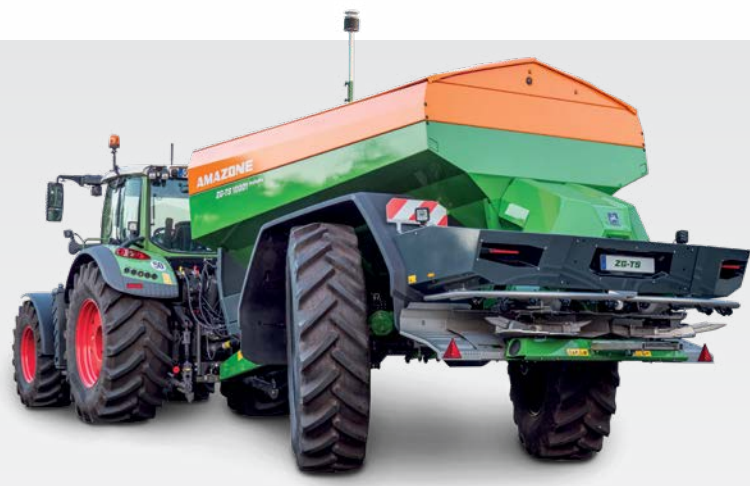
Asse di incidenza con angolo di sterzata fino a 28°
