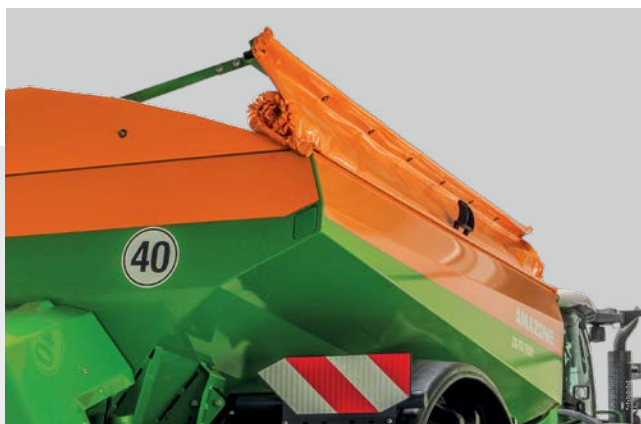
✔ Copritramoggia avvolgibile d azionamento idraulico
