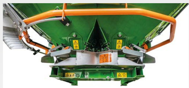
Deflettore meccanico fissato direttamente dietro i dischi di spargimento
