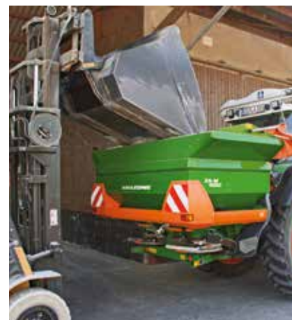
Riempimento con pala caricatrice industriale
