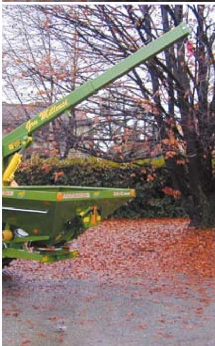
Braccio telescopico di utilizzo polivalente a comando idraulico, indicato per rifornire in modo rapido ed autonomo lo spandiconcime.
