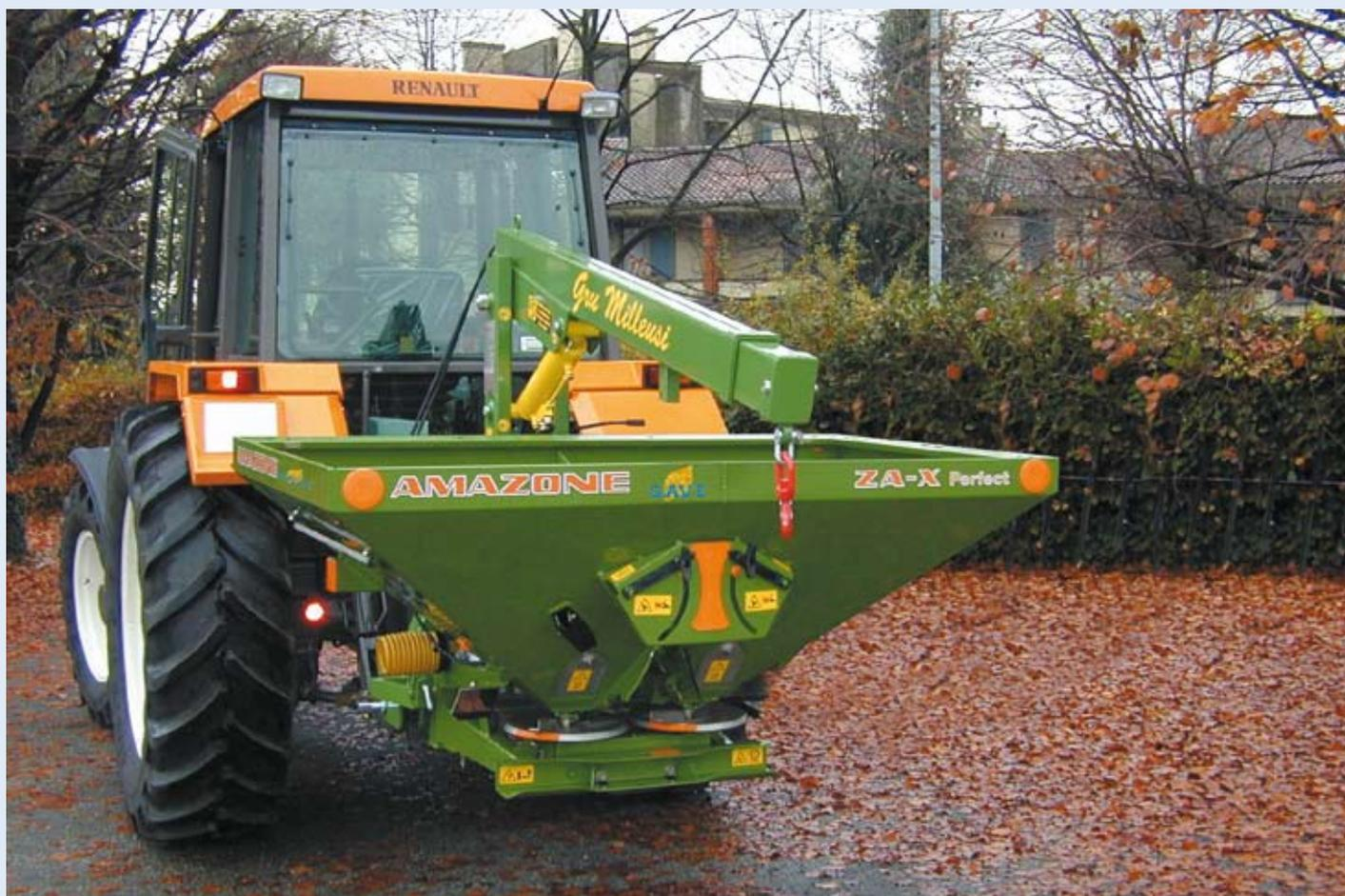
Gru idraulica portata con attacco a tre punti accoppiabile agli spandiconcime mediante attacchi di 2<sup>a</sup> categoria.
