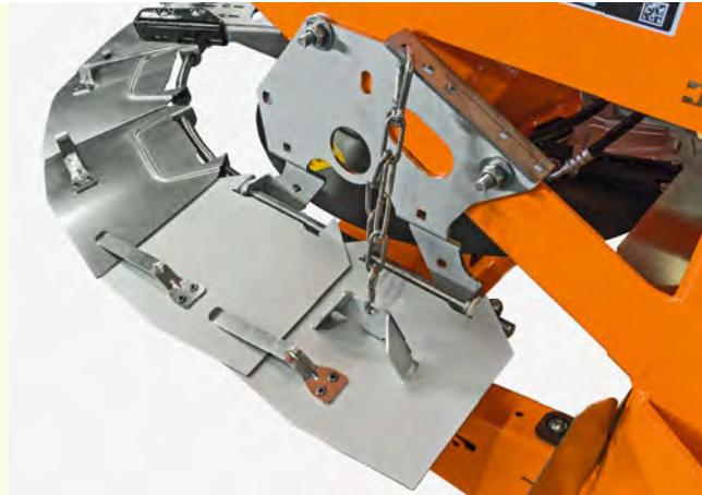
Nell'equipaggiamento base lo spandiconcime può essere usato anche senza computer di controllo. In questo caso la larghezza di lavoro viene adattata meccanicamente mediante lo schermo di spargimento.
