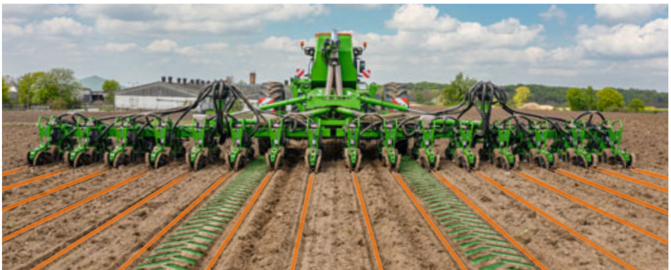
I segni delle ruote dell'assale Precea sono guidati tra le file di semina, senza duplicazioni, per proteggere il terreno
