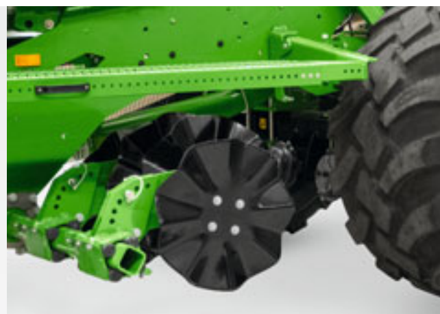
Regolazione meccanica della profondità dei rompitraccia a disco scanalato
