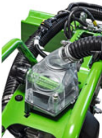
Unità di ricezione sopra l'unità di semina
