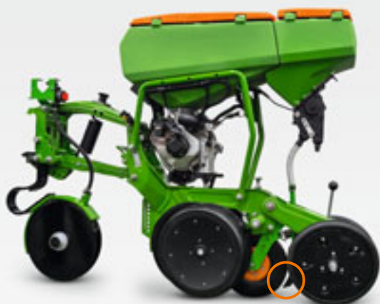
Microgranulatore Micro con punto di rilascio nella fila
