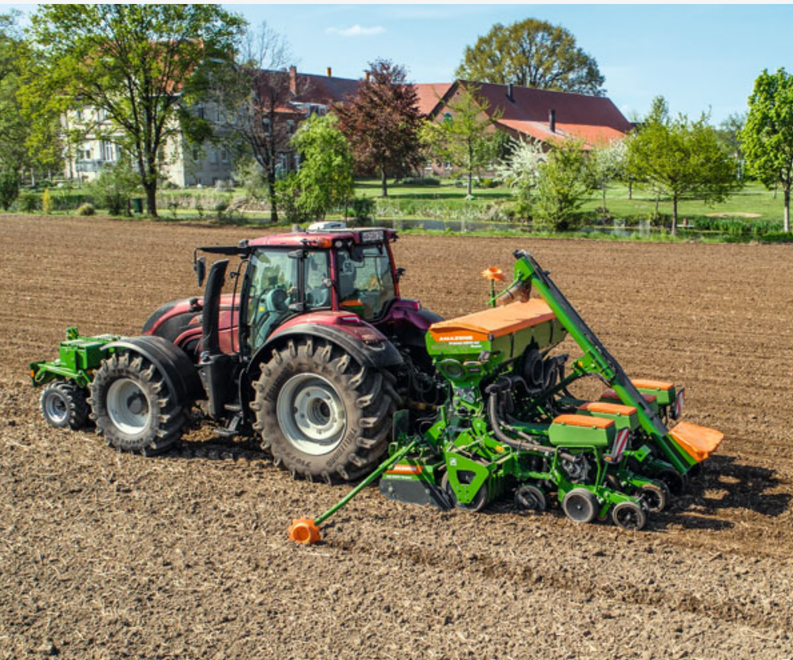
La Precea 3000-ACC con packer frontale in azione
