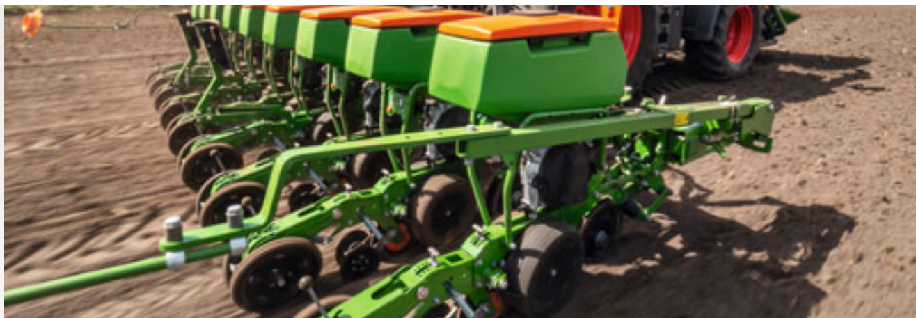
Tramogge della semente situate sopra il sistema di singolarizzazione
