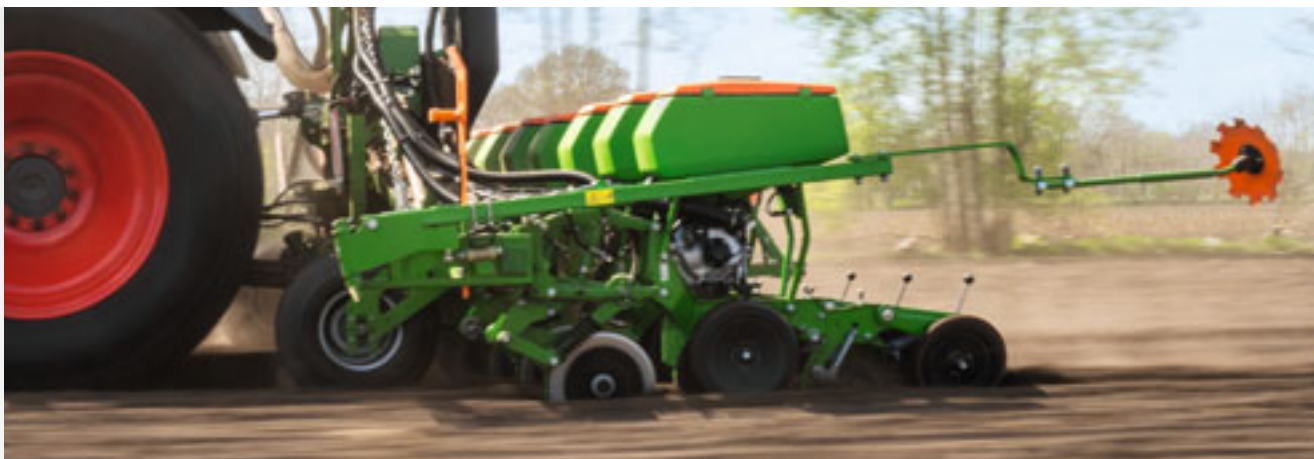
Precea 6000-2FCC con coltro localizzatore FerTeC Twin HD
