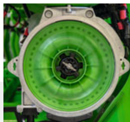
Disco di semina in funzione (senza coperchio)
