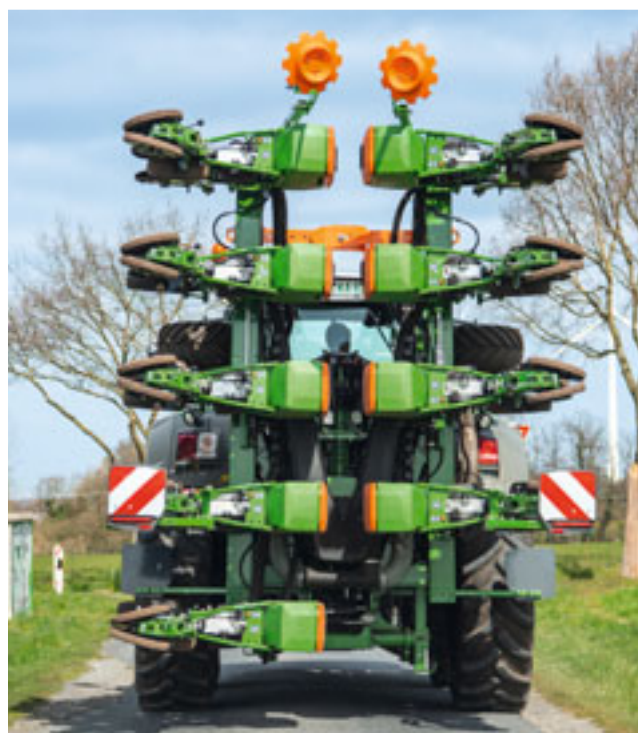
La Precea 6000-2FCC con 9 file ripiegate per il trasporto su strada
