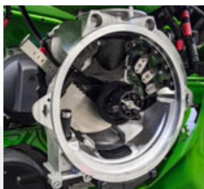
Vista sul sistema di dosaggio senza disco di semina
