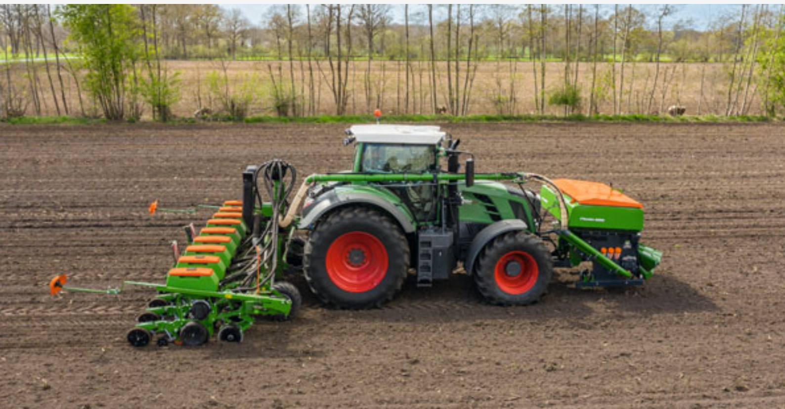
Tramoggia frontale portata FTender 2200 con seminatrice di precisione Precea 6000-2FCC
