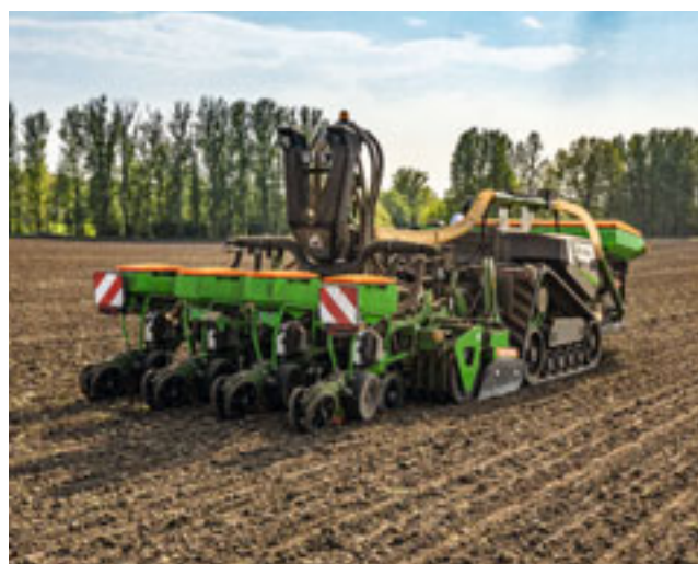
Precea 3000-AFCC con rotocultivatore KG
