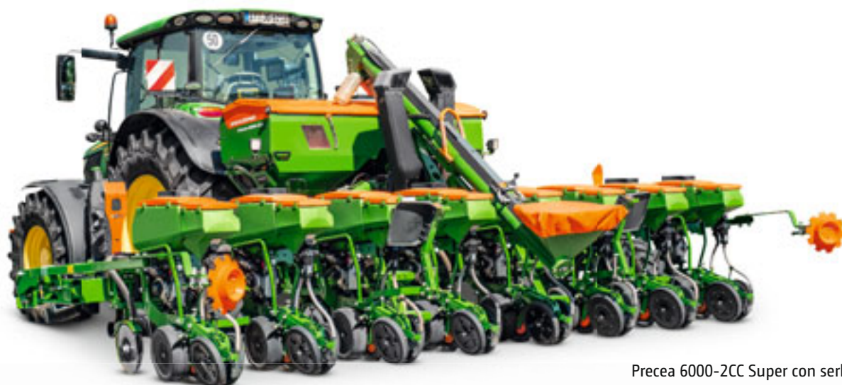
Precea 4500-2CC Super con serbatoio del concime posteriore e coclea di riempimento
