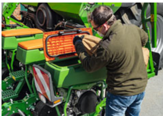
Le tramogge della semente sono ben accessibili e permettono il comando a una mano
