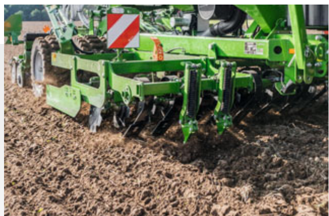
Combinazione di lama livellante a molle e rompitraccia trattore
