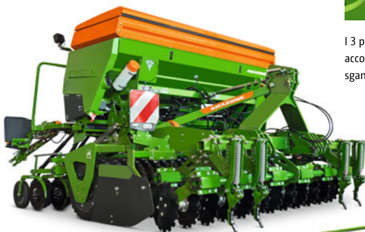
Erpice a dischi compatto portato CombiDisc con seminatrice portata con copriseme Cataya 3000 Super
