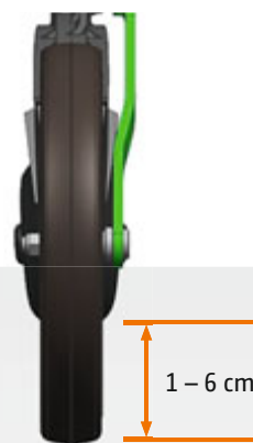
Profondità di lavoro del rullo di guida in profondità Control 50
