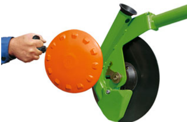
Coltro RoTeC (Ø 320 mm) con disco di guida in profondità Control 10
