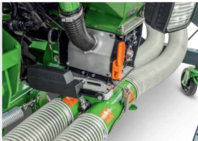
Commutazione elettrica di mezza larghezza nel dosatore della FTender
