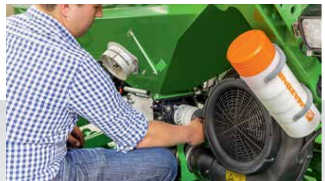
La buona accessibilità ai cilindri dosatori ne agevola la sostituzione
