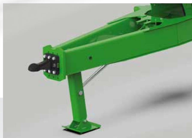
Barra di traino inferiore con giunto K80 e piede d'appoggio meccanico
