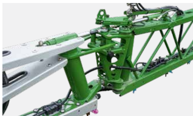
Il sistema antiurto a pressione idraulica situato all'estremità della barra (che funziona in base al principio della porta di saloon) può ripiegarsi all'indietro, in avanti e verso l'alto in presenza di ostacoli, assicurando un ritorno affidabile alla posizione di lavoro e una lunga vita utile.
