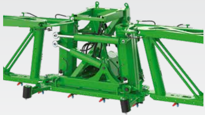
Sistema di compensazione delle oscillazioni per barre Super-L3 a partire da 39 m
