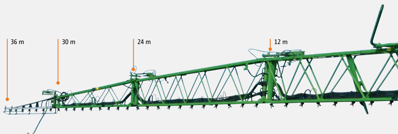
Barra Super-L2 con larghezza di 36 m, si richiude fino a 30 m, 24 m e 12 m
