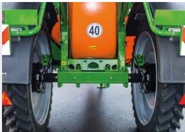
Assale regolabile con regolazione continua della carreggiata da 1,50 a 2,25 m per la UX 4201
