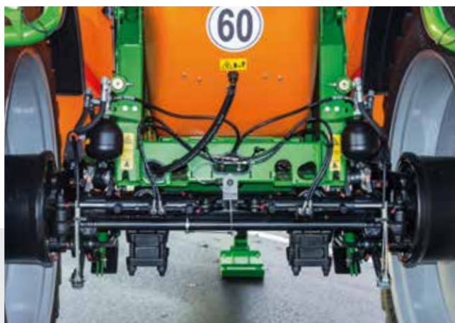
Sospensione idropneumatica degli assali con sterzata assale AutoTrail per la UX 4201 e la UX 5201
