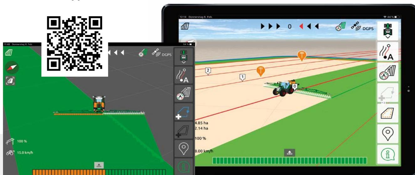
Viste mappa alternative con AmaTron Twin: visualizzazione chiara della macchina e delle sue larghezze parziali, nonché pulsanti sul lato destro del dispositivo mobile.
