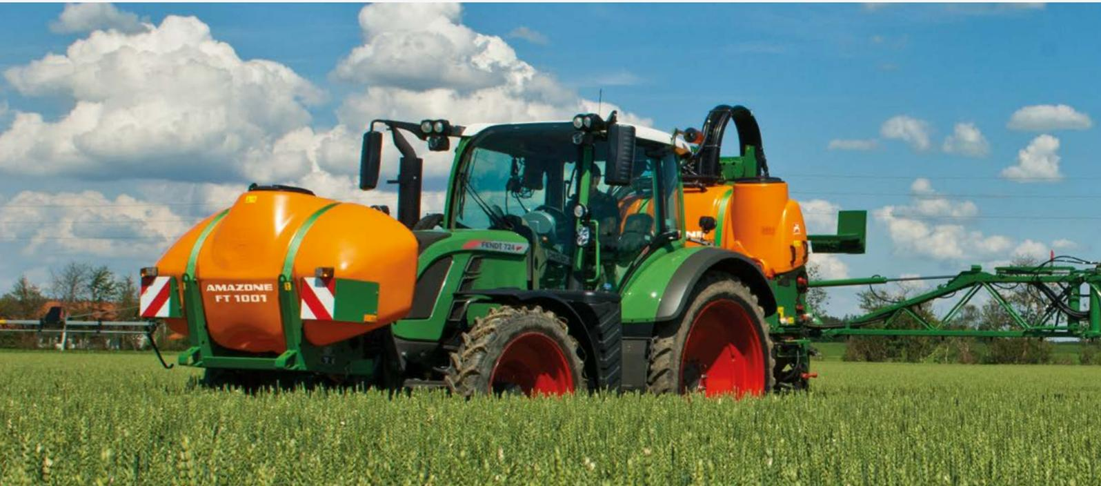
Il serbatoio frontale FT consente di ampliare molto facilmente la capacità complessiva dell'irroratrice portata UF di 1.000 l. Grazie alla struttura compatta, il serbatoio frontale è la soluzione ideale per ampliare la capacità della UF.
