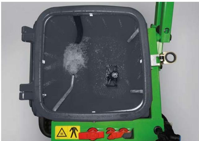
anteriore sinistra della centrale di comando. Il Power-Injector consente di ottenere grandi prestazioni. È lo stesso serbatoio di miscelazione Profi del polverizzatore trainato UX.
