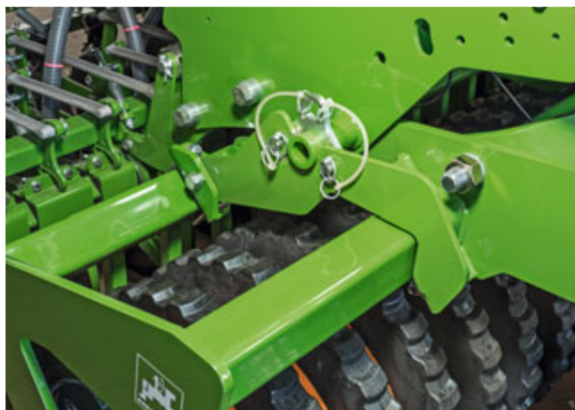
✓ Sistema di accoppiamento rapido QuickLink – per un collegamento e uno scollegamento semplici, veloci e senza utensili
