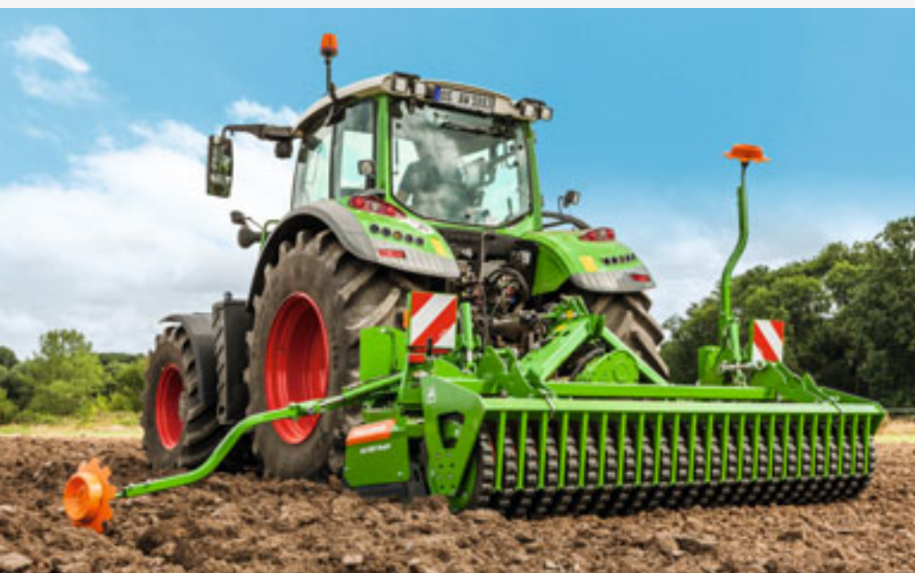
Erpice aratore KG 3001 Super con rullo ad anelli conici con profilo Matrix
