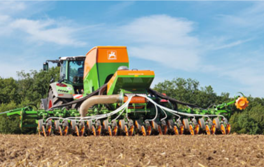
Seminatrice di precisione EDX, larghezza di lavoro 6 m
