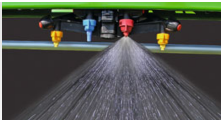
Controllo elettrico dei singoli ugelli AmaSelect con porta ugelli quadruplo e distanza tra gli ugelli di 50 cm o 25 cm
