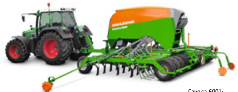
Cayena 6001: 36 ancore, distanza tra le file 16,6 cm – Velocità di lavoro fino a 15 km/h
