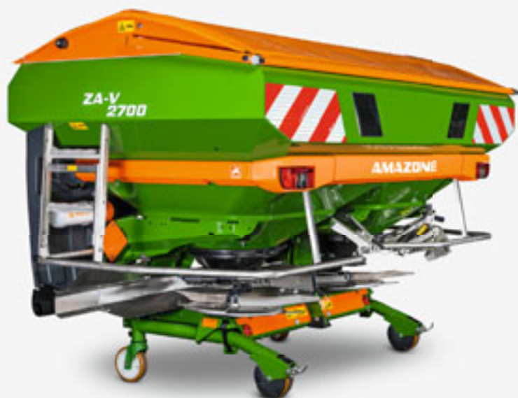
Spandiconcime a due dischi ZA-V 2700 Profis Tronic con scala pieghevole
