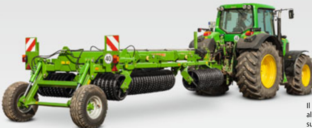
AW 9400, posizione di trasferimento – anche con omologazione per 40 km/ora (a seconda del Codice della Strada vigente).
