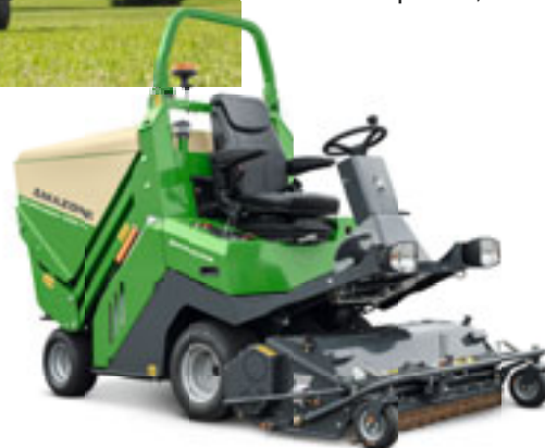
Profihopper 1250 iDrive SmartLine con trazione anteriore e sterzata a raggio 0
