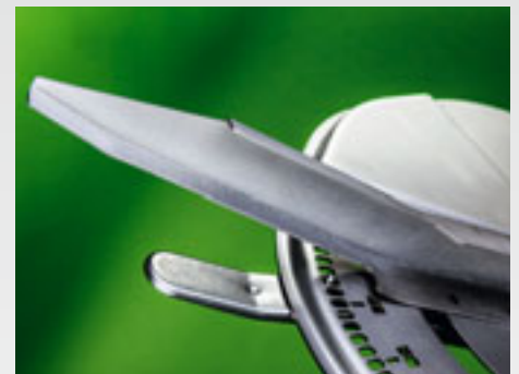
Disco di spargimento con sistema di regolazione QuickSet
