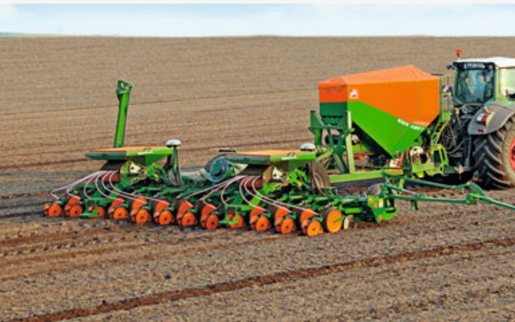
Seminatrice trainata di precisione EDX 9000-TC, larghezza di lavoro 9 m
