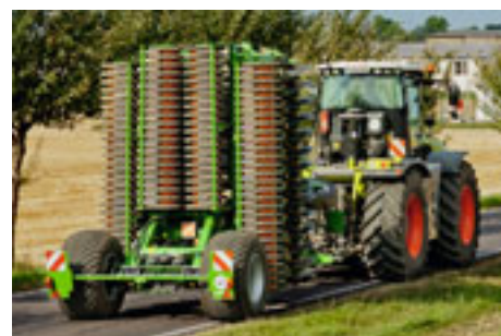
Sicurezza negli spostamenti su strada con larghezza di trasporto inferiore ai 3 m grazie al telaio a chiusura idraulica di serie.
