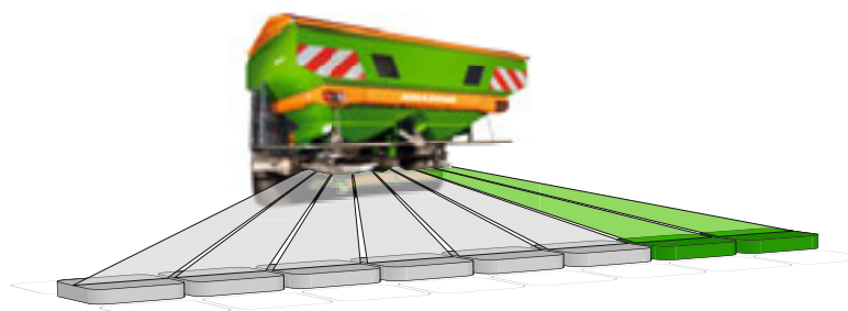
Con il controllo di 8 o 16 sezioni dello ZA-V è possibile controllare singole sezioni esterne
