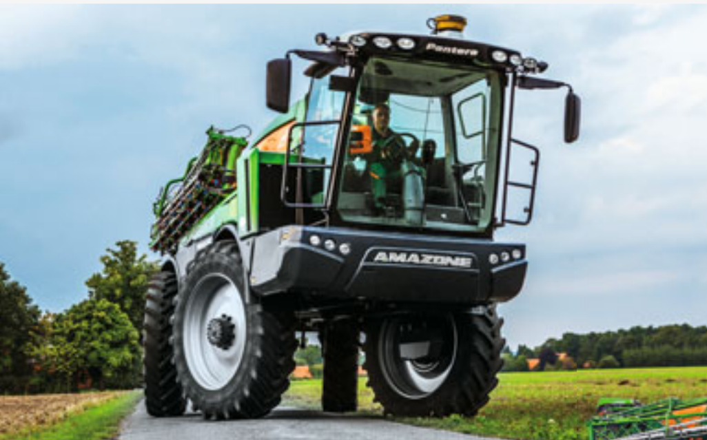
Polverizzatrice semovente Pantera 4503 con struttura compatta e sterzata su tutte le ruote
