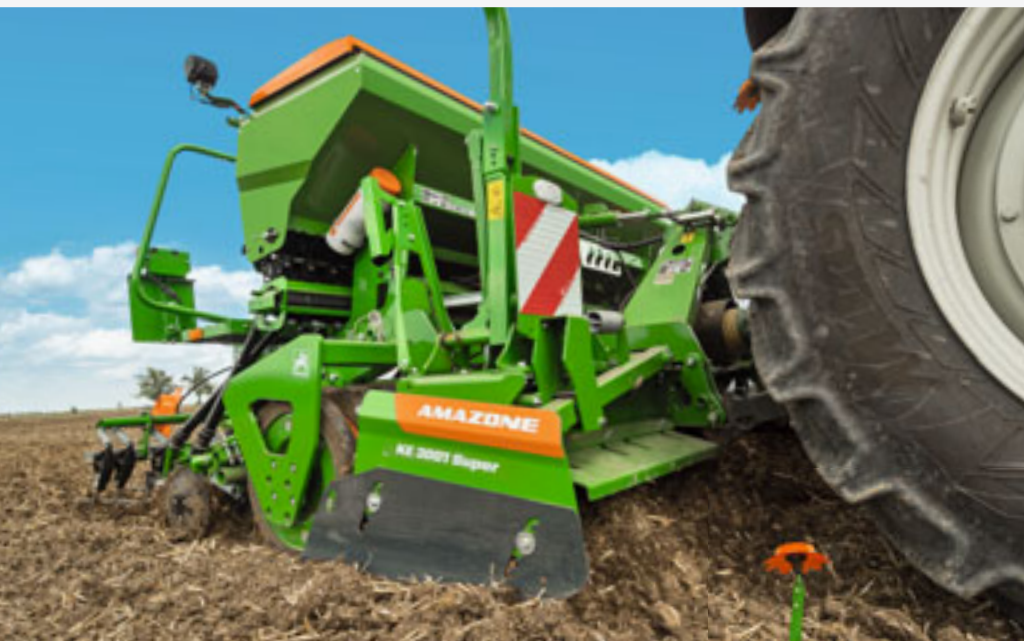
Erpice rotante KE 3001 Super con la seminatrice combinata Cataya 3000 Special
