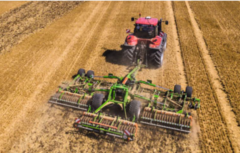
Catros+ 8003-2TX con rulli ad anelli conici con profilo Matrix nella larghezza di lavoro di 8 m
