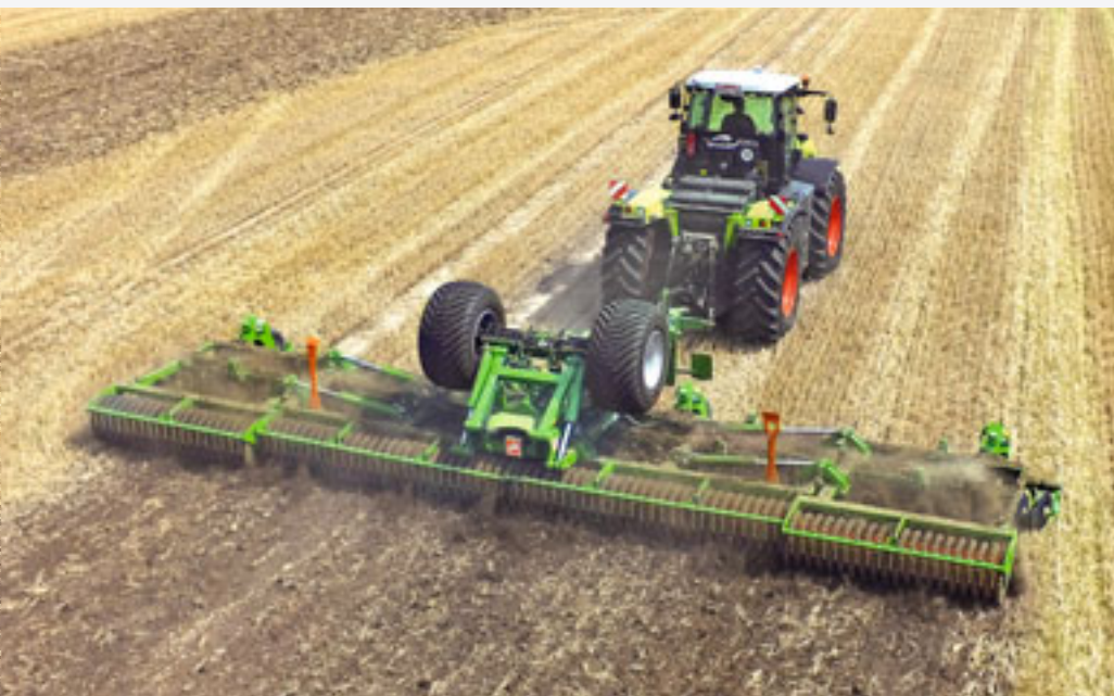
Catros + 12003-2TS con larghezza di lavoro 12 m durante la lavorazione delle stoppie
