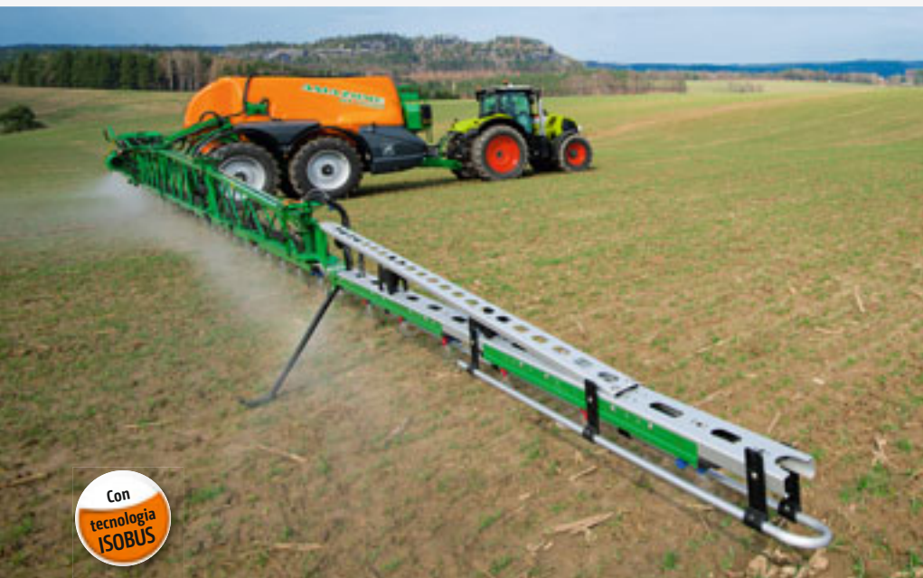
Polverizzatore trainato UX 11200 con barra Super L2 40 m
