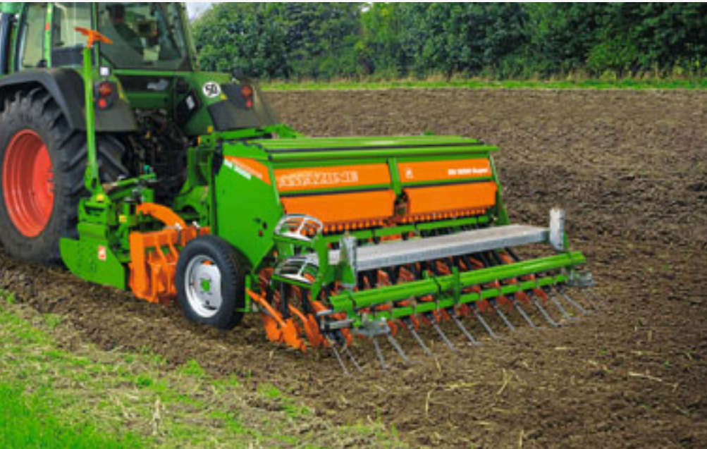
D9 3000 Super con copriseme in combinazione erpice rotante con e rullo packer dentato
