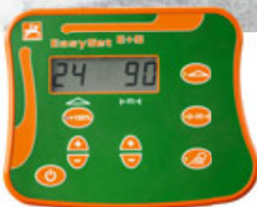
Computer di comando EasySet per il comando della paratoia o della larghezza di spargimento.
