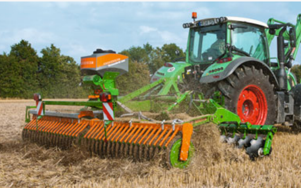
Catros+ 5002-2 con larghezza di lavoro 5 m e dischi dentati (diametro 510 mm)
