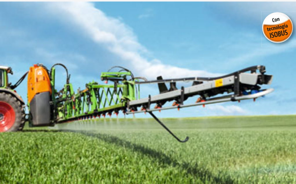
Polverizzatore portato UF 2002 con barra Super S2 30 m
