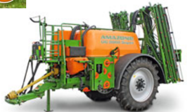
Polverizzatore trainato UG 3000 Super con barra Super S2 da 15 m a 28 m
