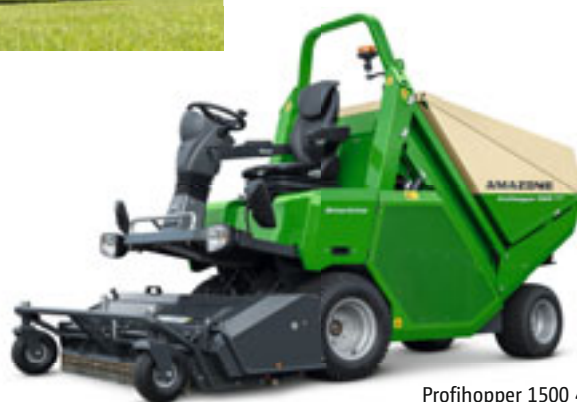
Profihopper 1500 4WDi SmartLine con trazione integrale intelligente e sterzata a raggio 0
