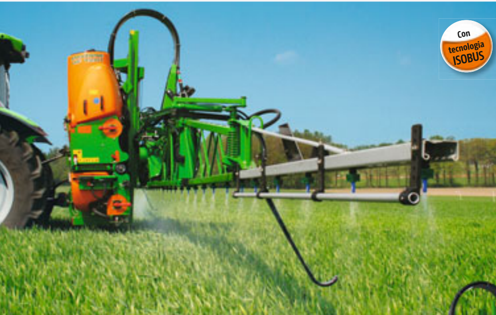
Polverizzatore portato UF 1201 con barra Super S2 18 m
