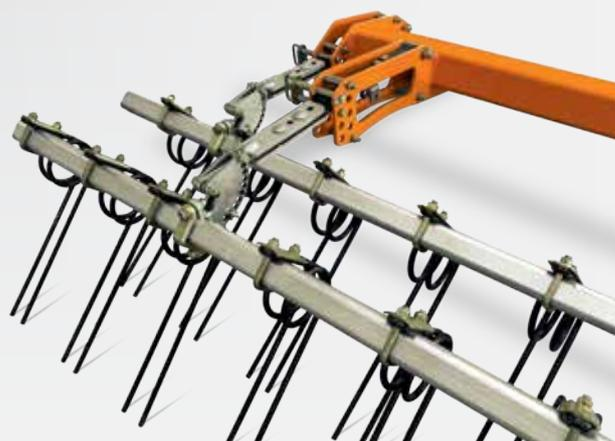
Sostituire il copriseme doppio è facile come sostituire o agganciare e sganciare il rullo posteriore, poiché si usa lo stesso telaio del rullo.
