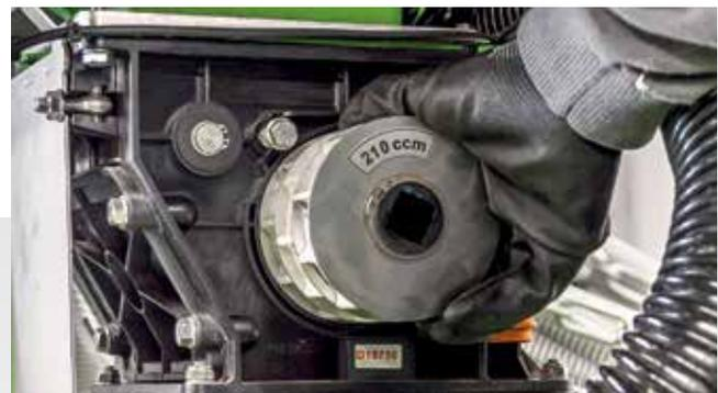
Facile sostituzione del cilindro dosatore
