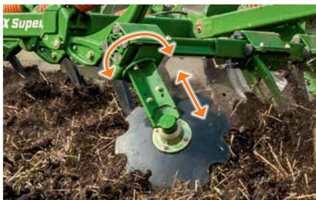
L'elemento laterale – regolabile separatamente in altezza e inclinazione
