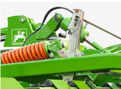
Alberini per la regolazione centralizzata dell'unità di livellamento sul Cenius-2TX
