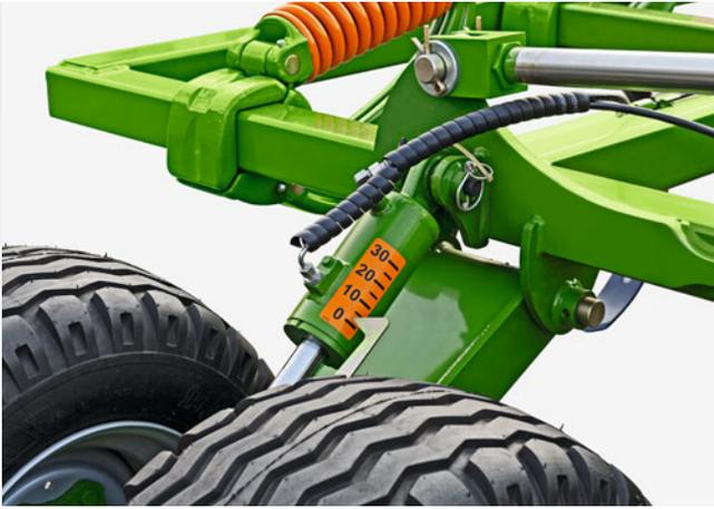
Scala graduata del dispositivo idraulico per la regolazione della profondità di lavoro delle punte
