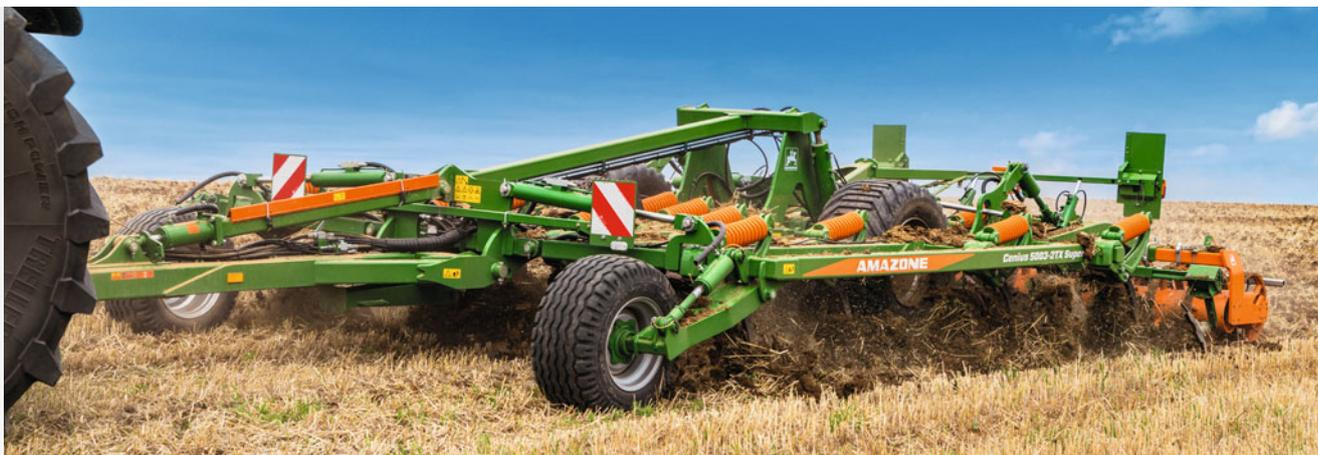
Lavorazione delle stoppie con Cenius 5000-TX Super con denti C-Mix-Super
