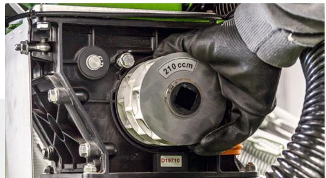
Facile sostituzione del cilindro dosatore
