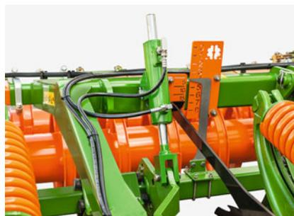
Cilindro idraulico per la regolazione della sezione da livellare
