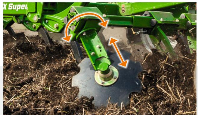
L'elemento laterale – regolabile separatamente in altezza e inclinazione
