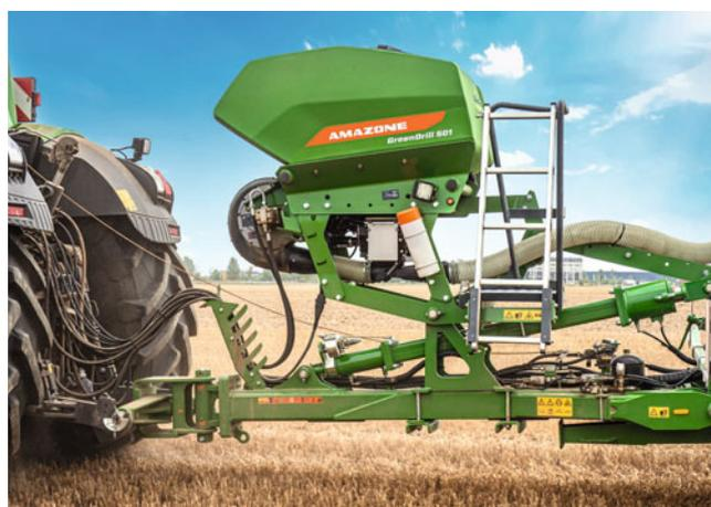
GreenDrill 501: per tutte le macchine trainate con volume della tramoggia di 500 l e ventola idraulica
