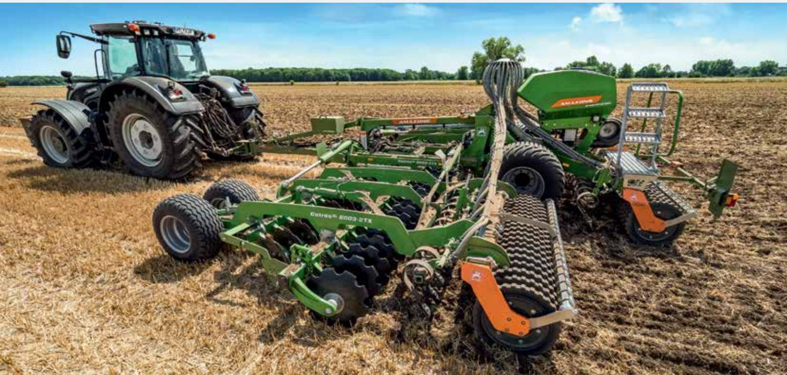
Catros<sup>XL</sup> 8003-2TX durante la lavorazione delle stoppie con un GreenDrill montato in alto per la semina di colture intercalari
