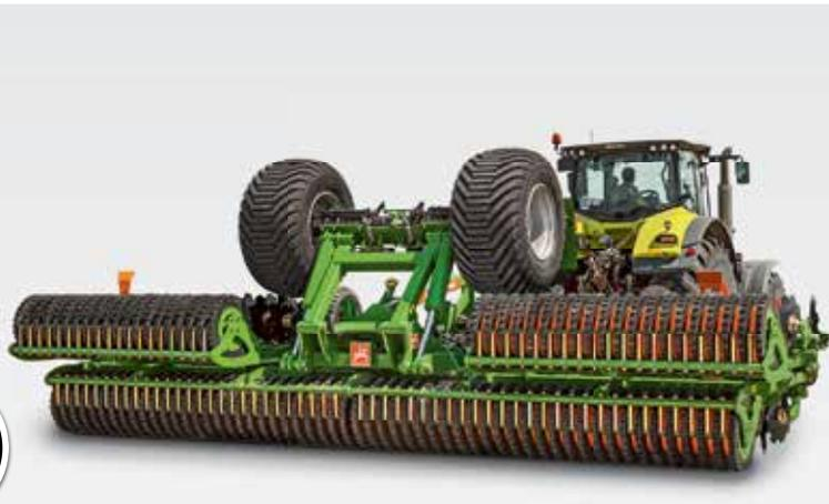
**!** «Una larghezza di tre metri, un'altezza inferiore a quattro metri e omologato per 40 km/h: efficiente anche durante il trasporto.»
