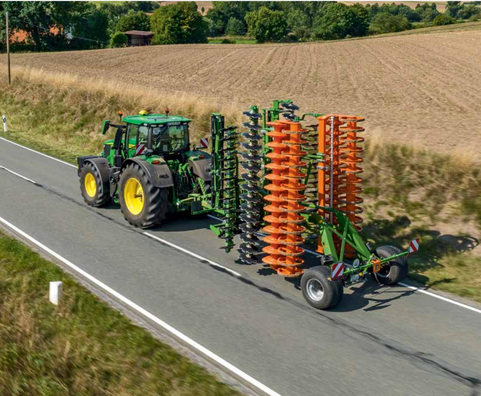
❗ «L'attacco mediante i bracci inferiori assicura una buona maneggevolezza in capezzagna».
