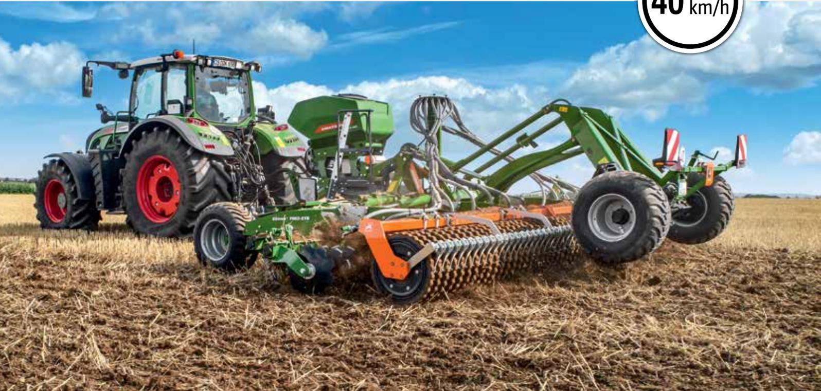
Catros+ 7003-2TS utilizzato per la rottura delle stoppie
