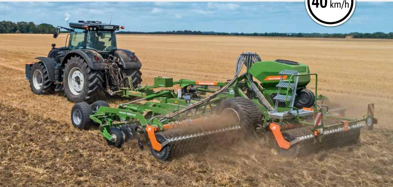
Catros<sup>XL</sup> 8003-2TX utilizzato per la rottura delle stoppie
