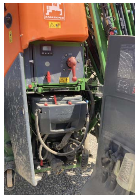
Impianto di incorporamento e comandi per la gestione del carico ben protetti sul fianco sinistro della cisterna
