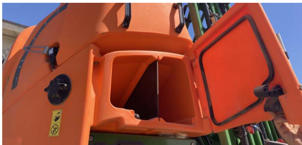
Vano per tute e indumenti contaminati
