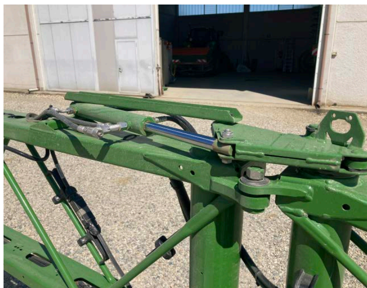
Snodo ammortizzato, uno degli elementi di stabilità della barra Amazone
