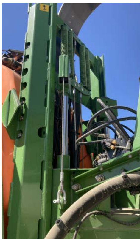
Sistema di ammortizzamento su tre elementi distinti. Secondo il proprietario, funziona alla perfezione
