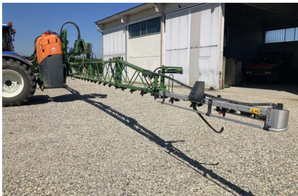
Barra da 21 metri in acciaio, con elemento terminale in alluminio
