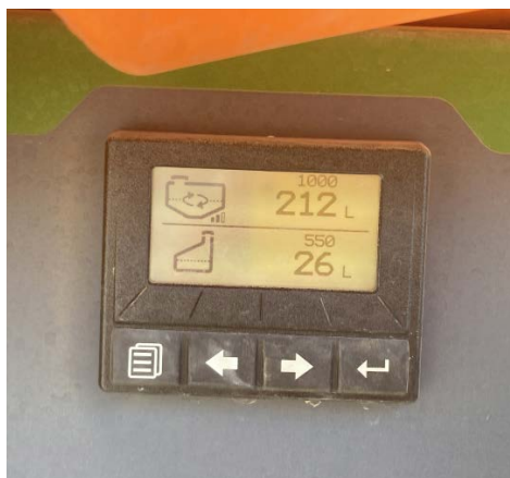
Schermo a cristalli liquidi per caricamento e dosaggi. Visibili, comunque, anche dalla cabina del trattore tramite display Isobus
