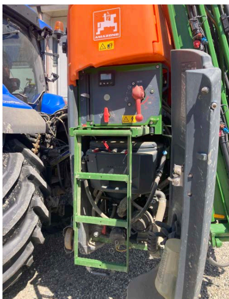
Scaletta a scomparsa per il controllo o interventi sulla parte alta della cisterna
