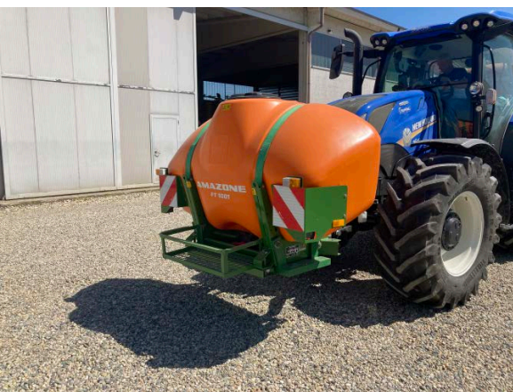
Cisterna supplementare da mille litri sul sollevatore anteriore. Aumenta di un terzo l'autonomia della UF 1602
