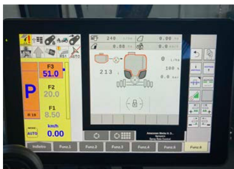
Con la connessione Isobus la UF si controlla dal monitor del trattore
