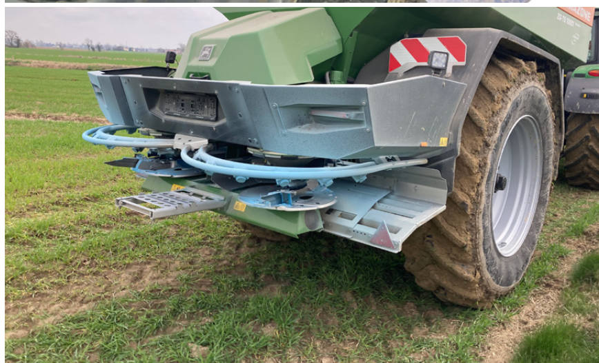
Il sistema di distribuzione TS ad alimentazione idraulica è il cuore dello spandiconcime
