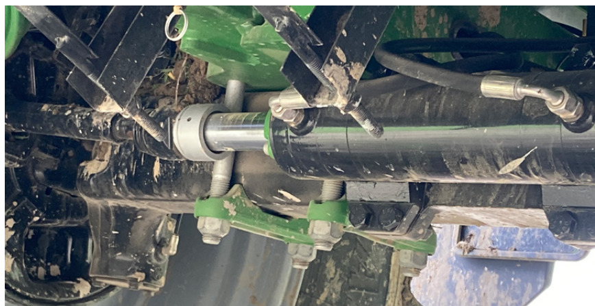
Assale sterzante, con 28° di angolo, utile anche per mantenere la macchina in traiettoria durante il lavoro su pendenze trasversali
