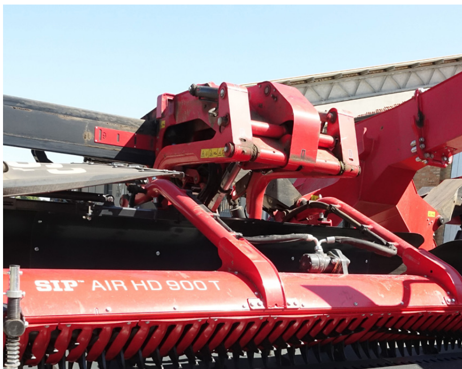
Il sistema di sospensioni idropneumatiche assicura un'eccellente reattività e una pressione costante sul terreno
