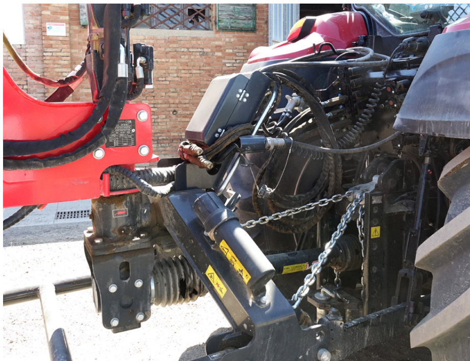
Attacco flessibile a 2 punti con doppia pompa idraulica azionata tramite presa di forza
