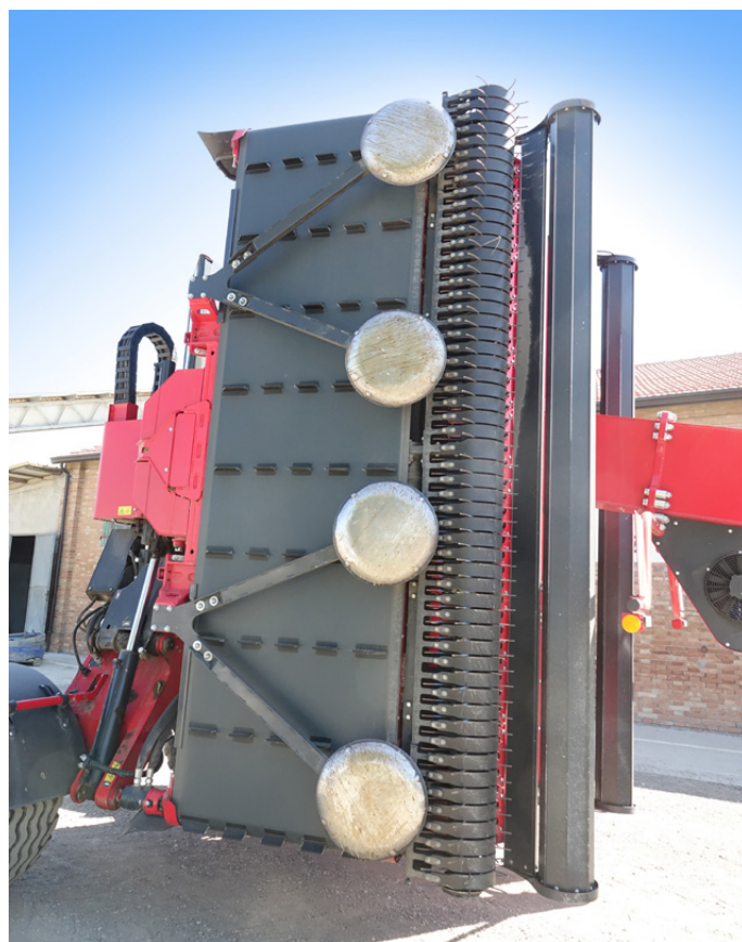
I dischi folli, installati in prossimità del pick-up, assicurano un'alta reattività e un ottimo adattamento al terreno. Inoltre limitano l'usura del pick-up
