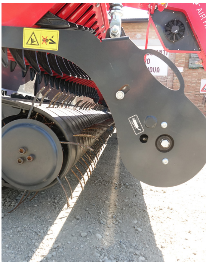
Il pick-up con rotore di diametro ridotto assicura un convogliamento fluido senza turbolenze e accumuli di foraggio nella parte anteriore del ranghinatore
