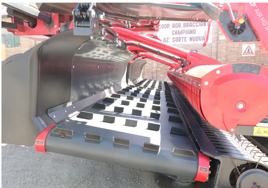
Il tappeto è bidirezionale e regolabile in velocità in funzione della velocità di avanzamento e della quantità di prodotto
