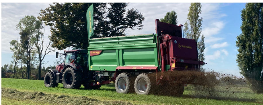
Grazie a una pesa dinamica, gli spandiletame serie VS e PS possono fare distribuzione a dosaggio variabile
