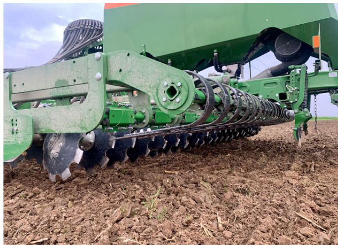
Dischi ondulati per incisione residui e lavorazione del terreno
