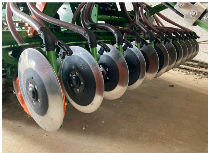
La semina è affidata a 48 dischi disposti su tre file. Fanno capo a una tramoggia divisa in due e dotata di un doppio dosatore
