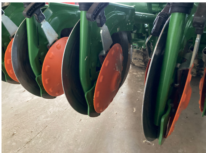
L'elemento di semina a disco singolo si è dimostrato particolarmente efficiente su terreno bagnato
