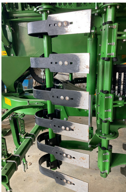
Una fila di palette a molla prepara il terreno alla lavorazione e semina
