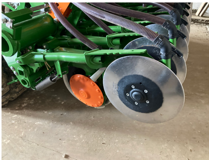
Elemento di semina a disco singolo di tipo Rotec Plus
