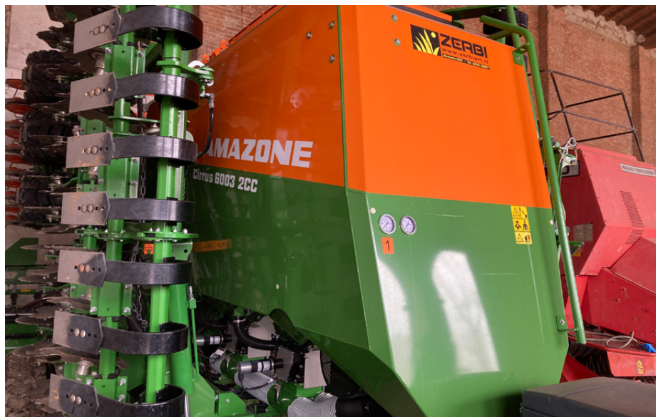
Serbatoio del concime da 4mila litri complessivi, in grado di assicurare un'elevata autonomia. Risulta però difficile da riempire se non si dispone di telescopico con un buon braccio
