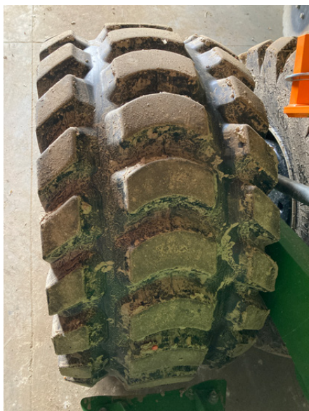
Rullo di compattamento del terreno. La semina avviene in corrispondenza dei tre ordini di tasselli presenti sulla ruota
