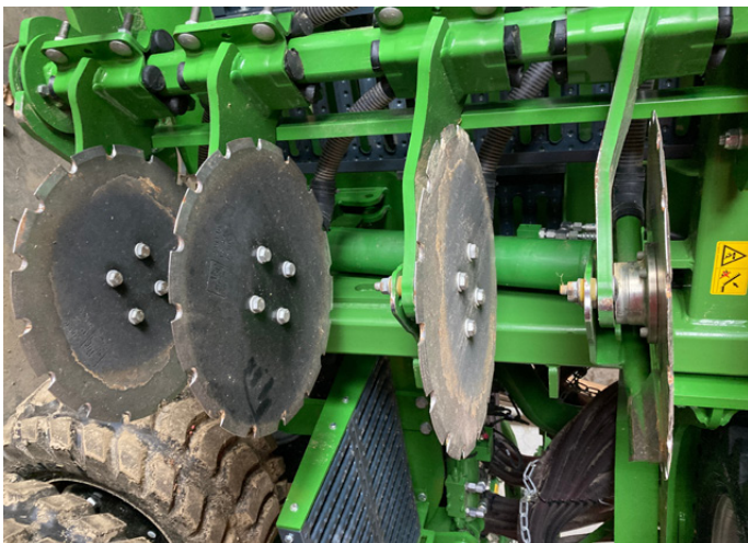
La macchina dispone di 34 dischi per semina di concime o cover crop, serviti da un apposito serbatoio
