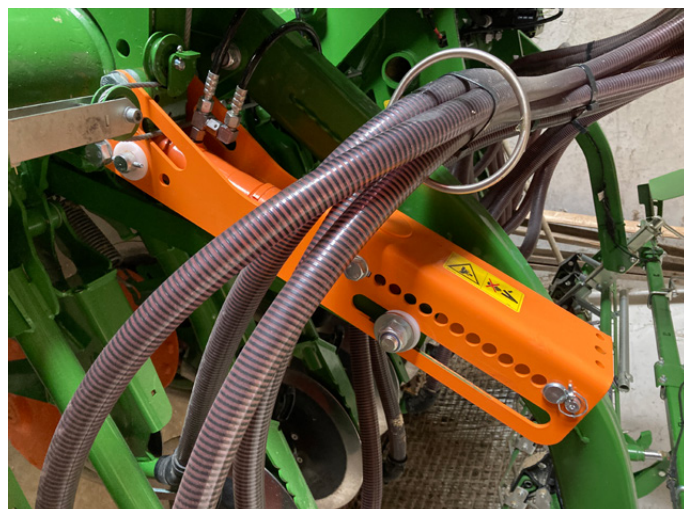
Sistema di regolazione della pressione al suolo a regolazione manuale. Può caricare fino a 100 kg su ogni elemento
