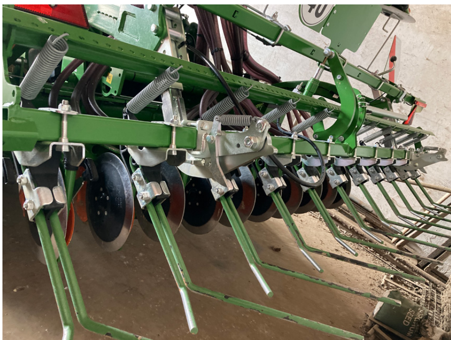
Erpice a molle per la copertura del seme e il livellamento finale del terreno
