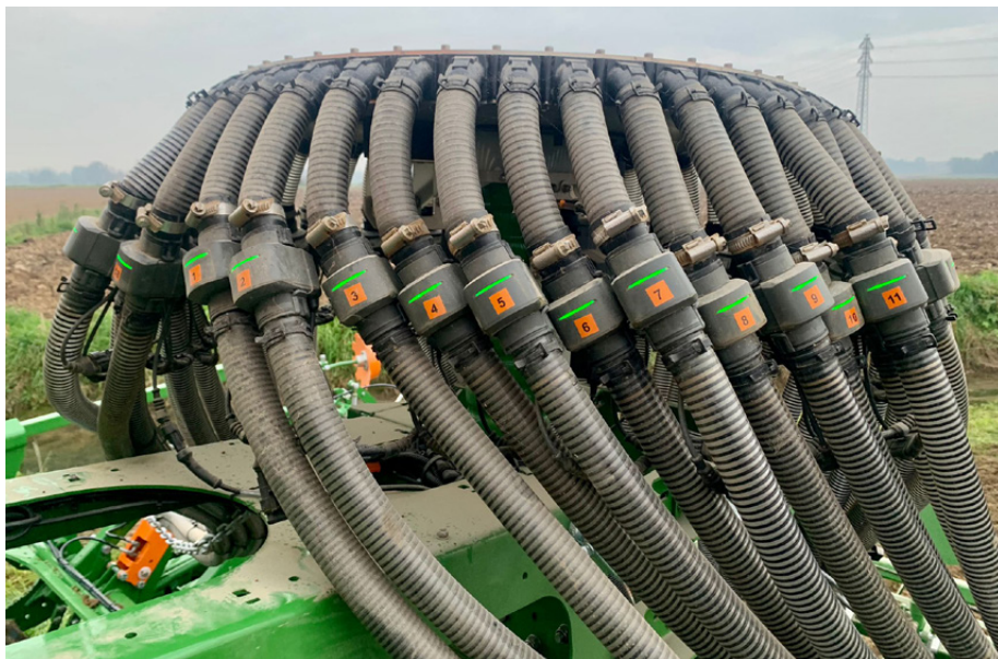
Dosatore per il sistema di trasporto pneumatico. È dotato di 48 calate con controllo elettronico del passaggio del seme
