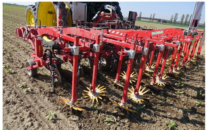
Ogni parallelogramma, di elevata lunghezza, è dotato di una molla di trazione, al fine di ottimizzare l'incidenza a terra degli elementi sarchianti posti sulla fila (fino a 105 kg per elemento)
