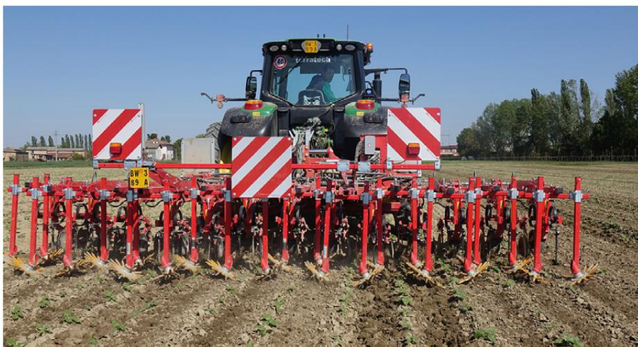
La Row-Guard in dotazione alla Terratech, qui al lavoro su piantine di girasole, opera solo con interfila 45 cm
