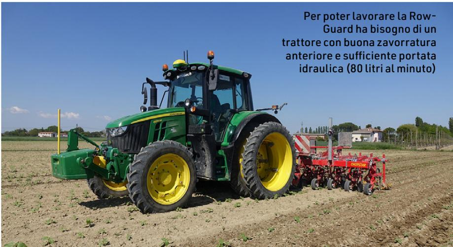
Per poter lavorare la Row-Guard ha bisogno di un trattore con buona zavoratura anteriore e sufficiente portata idraulica (80 litri al minuto)
