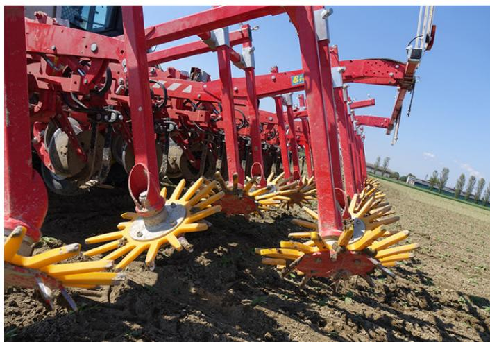
Primo piano delle stelle rotanti "finger weeder"
