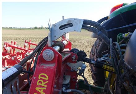
Telaio con capacità totale di traslazione pari a 500 mm
