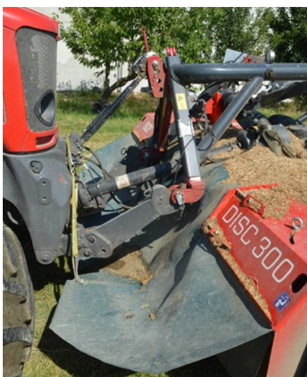
Il telo di protezione originale era insufficiente ed è stato sostituito con uno più largo ed efficace
