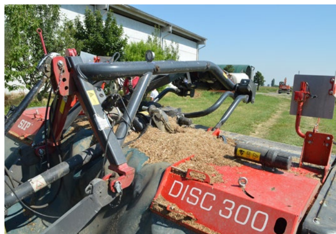
Il sistema S Flow fa in modo che la barra anteriore sia trascinata e non spinta dal trattore
