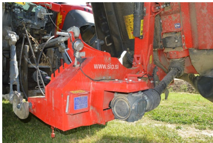
Sistema di innesto della barra laterale, con sospensione idropneumatica per assicurare il galleggiamento
