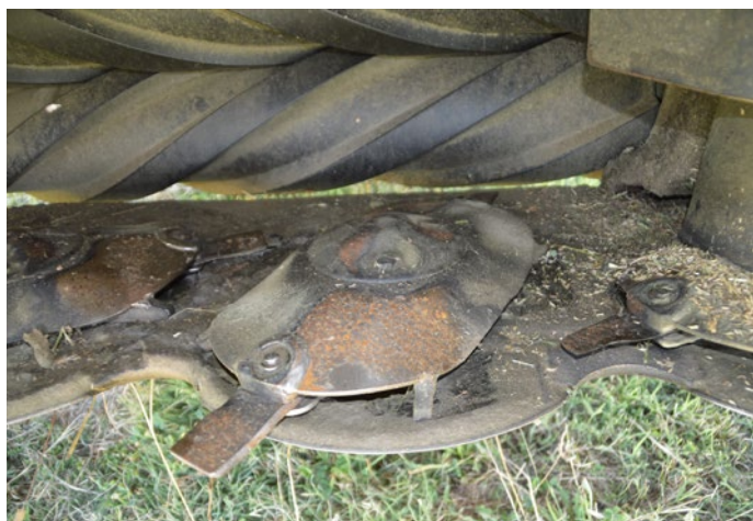
Disco di taglio di forma allungata con bullone di fissaggio singolo sulle lame
