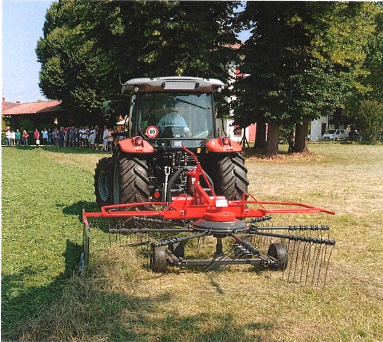
La serie Star utilizza bracci porta denti rimovibili singolarmente e realizzati con tubolari particolarmente leggeri, mentre il guscio della scatola rotore è realizzato in lega di alluminio.
