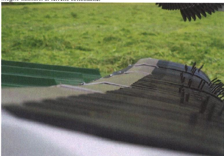
Inoltre i 6 denti dei moduli del pick-up sono assemblati all'albero centrale mediante una vite e un particolare morsetto che permette poi ai denti eventualmente rotti di rimanere nella loro posizione.
