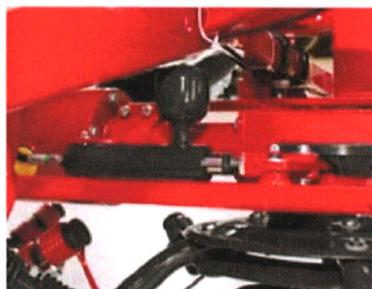
Il cilindro idraulico che controlla lo sterzo è azionato da un distributore a 2 vie, i ritorni di pressioni sono ammortizzati da un accumulatore a gas.
