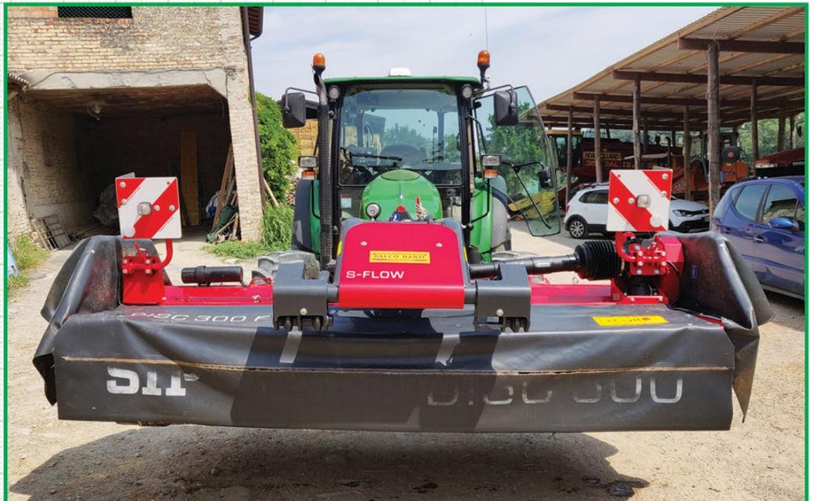
Queste ultime si rompono in caso di sovraccarico permettendo la rotazione libera/a vuoto del disco. Il disco ha uno spessore di 5 mm mentre le slitte della barra falciante di appoggio al terreno sono pressate a freddo in acciaio HARDOX. Il condizionatore a due rulli in gomma ha trazione singola sul rullo inferiore.
