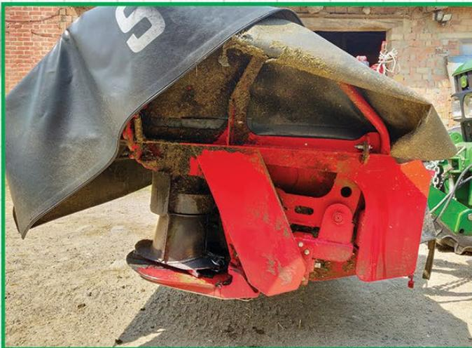
Per il trasferimento su strada si chiudono le protezioni laterali, si mettono i fari e la segnaletica in posizione verticale e si regola la sospensione nella posizione statica per la strada.
