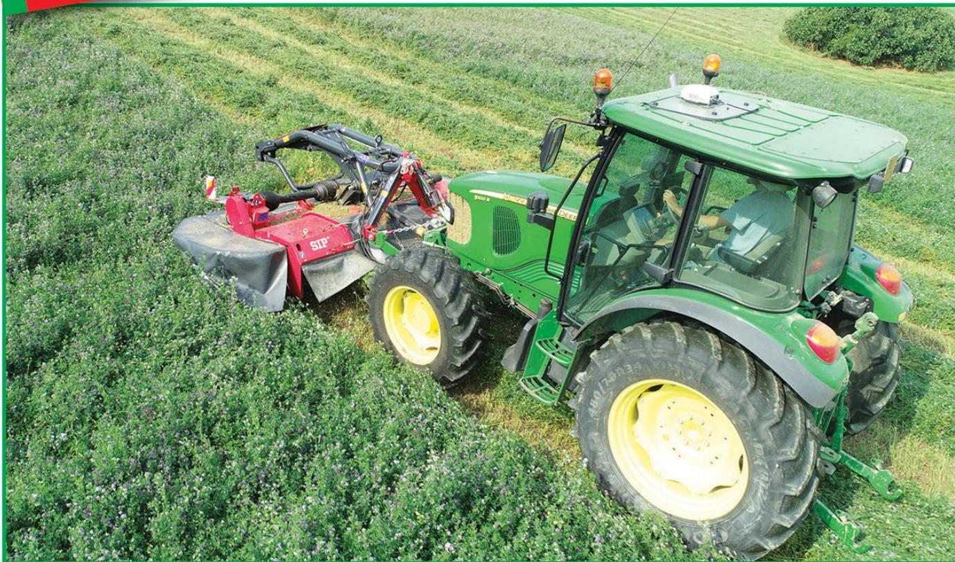
per parte è garantita sempre dalla struttura trainante a parallelogramma che permette la variazione dell'altezza di ogni singolo lato dell'attrezzatura. Al telaio con il classico connettore per le luci stradali si inseriscono i kit di segnalazione ripiegabili per una maggiore visibilità durante il lavoro.
