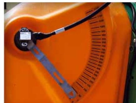
Sul serbatoio anteriore nel lato rivolto verso la cabina del trattore è presente l'**indicatore di livello** ben visibile dal posto di guida
