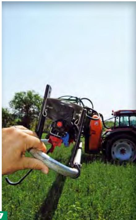
**6.** La barra di distribuzione è montata sul telaio mediante sistema di sollevamento verticale a azionamento idraulico, per un'escursione complessiva da un'altezza minima di 0,5 m a un'altezza massima di 2,2 m. Il doppio sistema di molle (vedi freccia) è utile per l'assorbimento dei carichi e delle oscillazioni durante il lavoro a favore di un'elevata stabilità della barra di distribuzione
