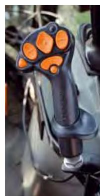
**Unità di controllo Amatron 3 per il controllo dei parametri funzionali** (es., ettari e ore lavorati, volume distribuito, sezioni in uso) associata a **joystick multifunzione** per la gestione dell'operatrice (ad es., controllo sezioni, controllo altezza e posizione barra di distribuzione)
