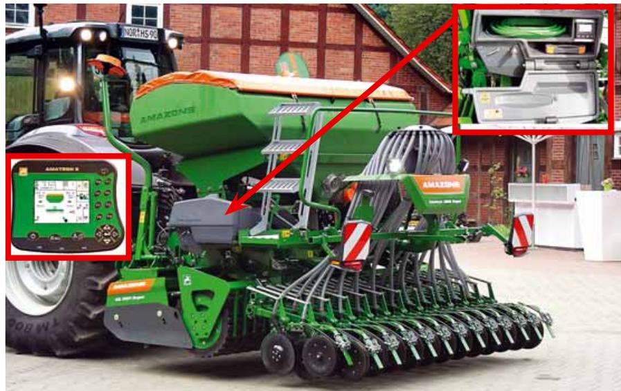
**Sulle seminatrici Centaya troviamo regolazione del dosaggio con Smart Center e Twin Terminal (riquadro in alto) mentre sul distributore pneumatico la chiusura elettrica consente le tramline o la chiusura di metà della larghezza di lavoro utile in appezzamenti irregolari. Sono disponibili l'ISO-Bus e interfacce elettroniche come Amapad o Amatron (riquadro a sinistra). Per la semina di cover crops è disponibile la tramoggia Green Drill 200 con distributore elettrico**
