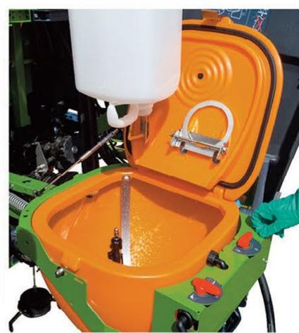
Per l'introduzione di polveri o agenti granulari è presente un ugello di miscelazione aggiuntivo che impedisce in modo sicuro qualsiasi blocco dell'apertura di aspirazione.
