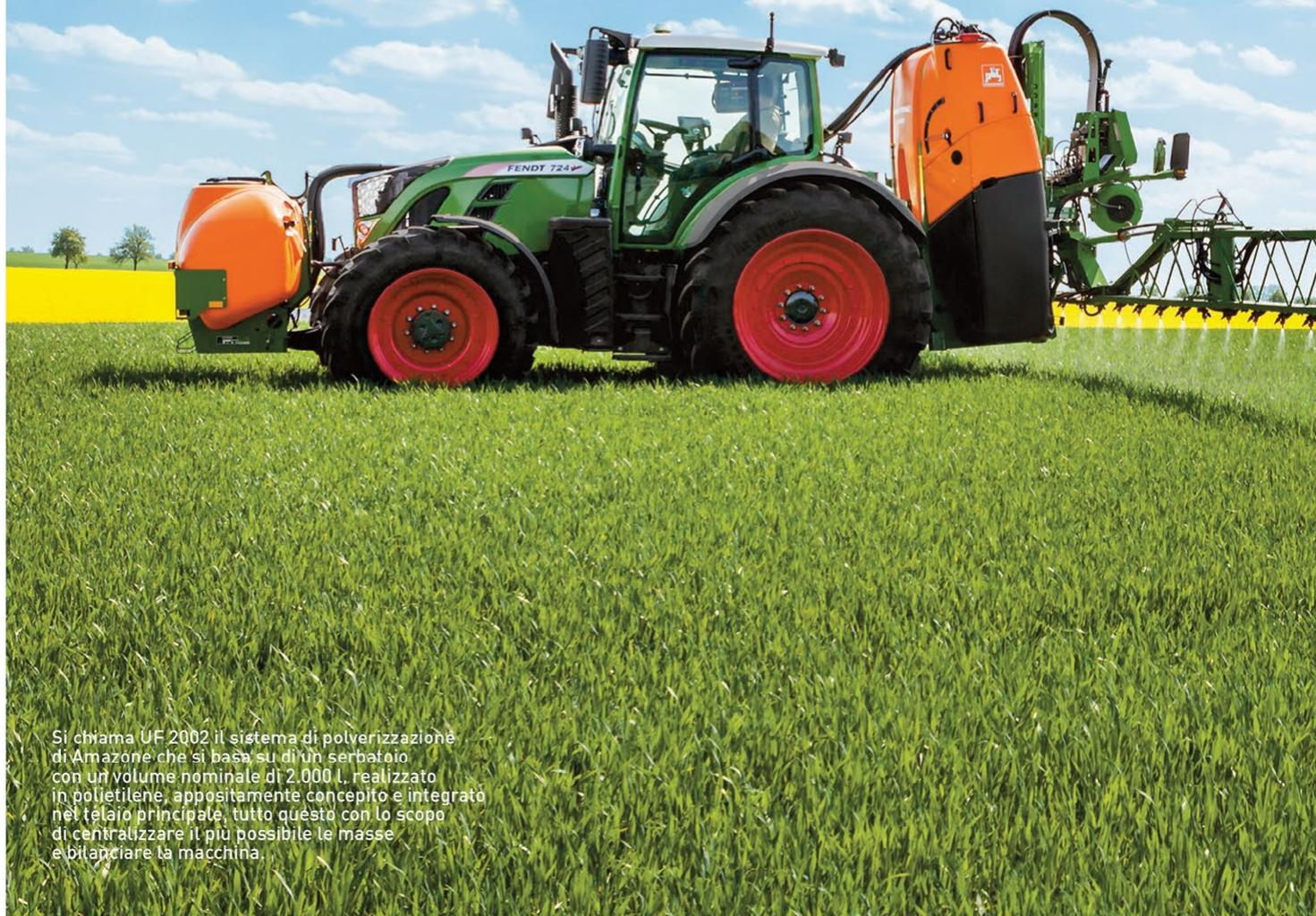
Si chiama UF 2002 il sistema di polverizzazione di Amazone che si basa su di un serbatoio con un volume nominale di 2.000 l, realizzato in polietilene, appositamente concepito e integrato nel telaio principale, tutto questo con lo scopo di centralizzare il più possibile le masse e bilanciare la macchina.
