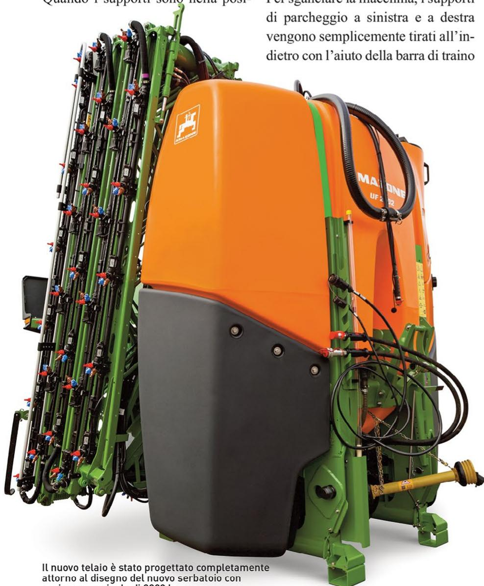
Il nuovo telaio è stato progettato completamente attorno al disegno del nuovo serbatoio con capienza nominale di 2000 l.
