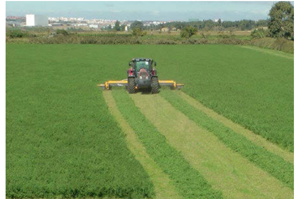
La larghezza di lavoro complessiva della macchina è di 7,3 m e la richiesta di potenza è di 130-150 cv.
