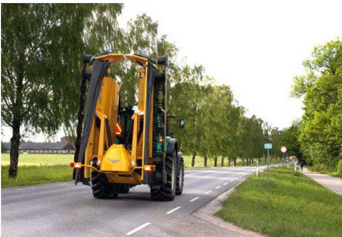
La macchina è pieghevole a una larghezza di trasporto di 2,80 m.
