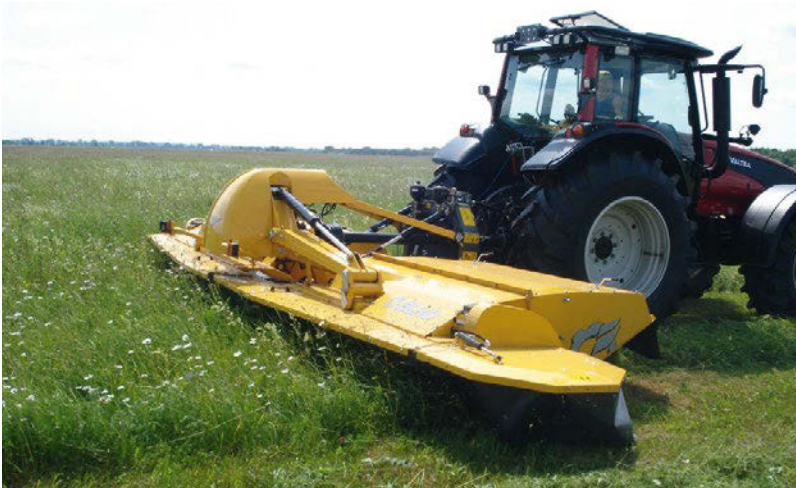
La larghezza di lavoro complessiva della macchina è di 7,3 m e la richiesta di potenza è di 130-150 cv.
