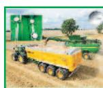
**Active Yield** ottimizza i dati forniti dai sistemi di misurazione della produzione di una mietitrebbia. Dispone di tre sensori per il peso all'interno della tramoggia capaci di rilevare le forze verticali all'aumentare del livello di riempimento e di raffrontarle con i dati forniti dal sensore di produzione tenendo conto della lettura del sensore umidità.
